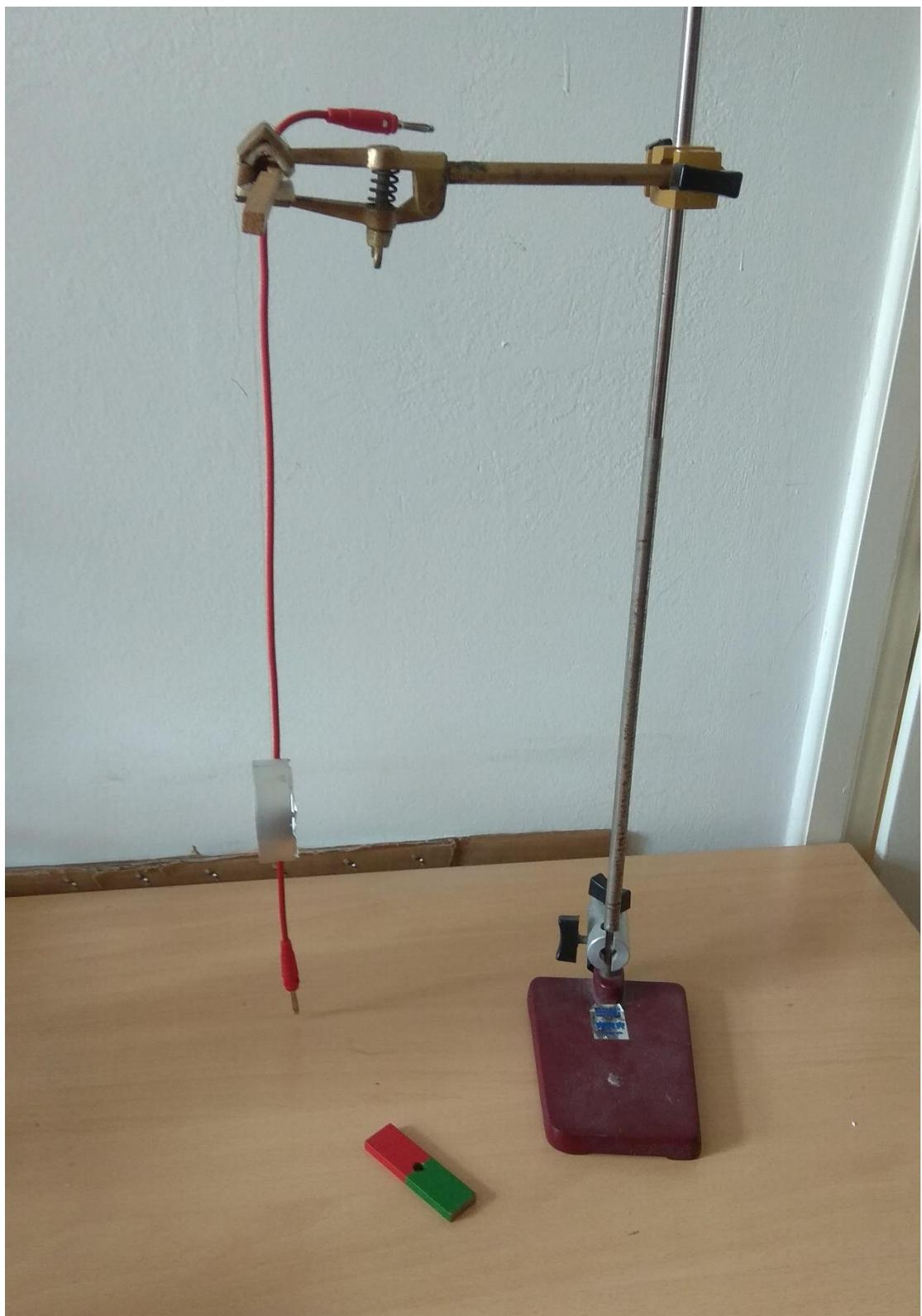
Slika 3.13. Složeni eksperimentalni postav za demonstraciju Lenzovog pravila
