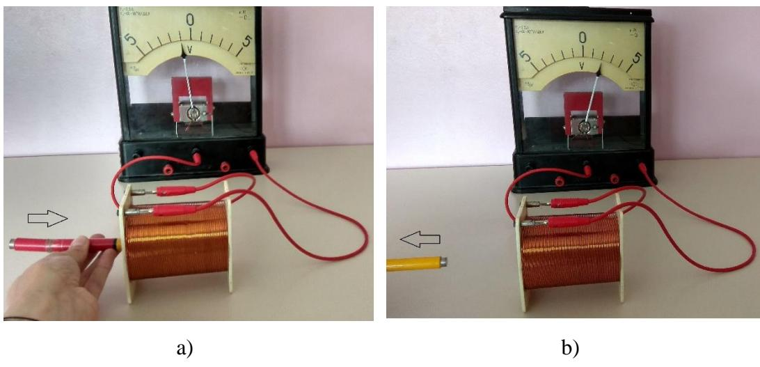
*Slika 3.9. Otklanjanje kazaljke galvanometra pri a) ulasku magneta u zavojnicu b) izvlačenjem magneta iz zavojnice*
