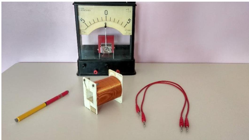
Slika 3.7. Eksperimentalni postav za ispitivanje pojave elektromagnetske indukcije
