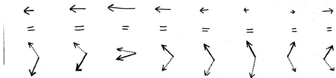
Slika 4.5. Pulsirajuće magnetsko polje i ekvivalent – prikazano vektorima
