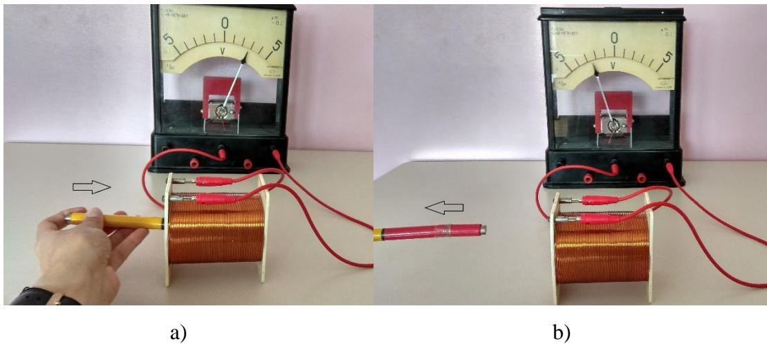
*Slika 3.10. Otklanjanje kazaljke galvanometra pri a) ulasku magneta u zavojnicu b) izvlačenjem magneta iz zavojnice*
