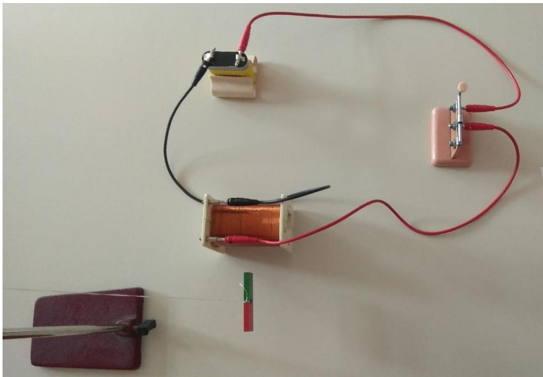
Slika 3.3. Eksperimentalni postav prije zatvaranja strujnog kruga
