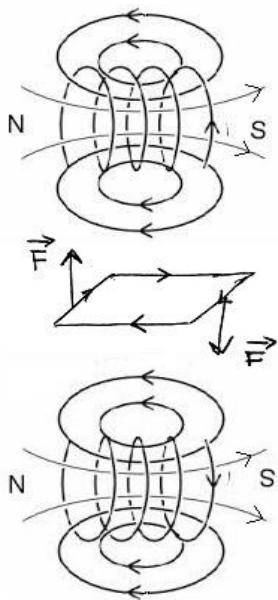
*4.6. Sile na mirujuću petlju u rezultantnom magnetskom polju dvije zavojnice kroz koje teče električna struja.*
