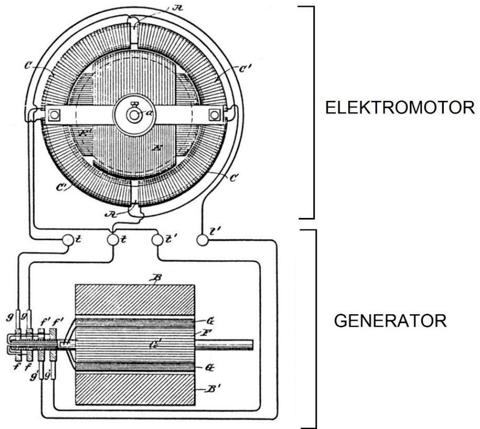
Slika 5.1. Shema Teslinog dvofaznog indukcijskog elektromotora. Preuzeto s (Tesla, 1888).
