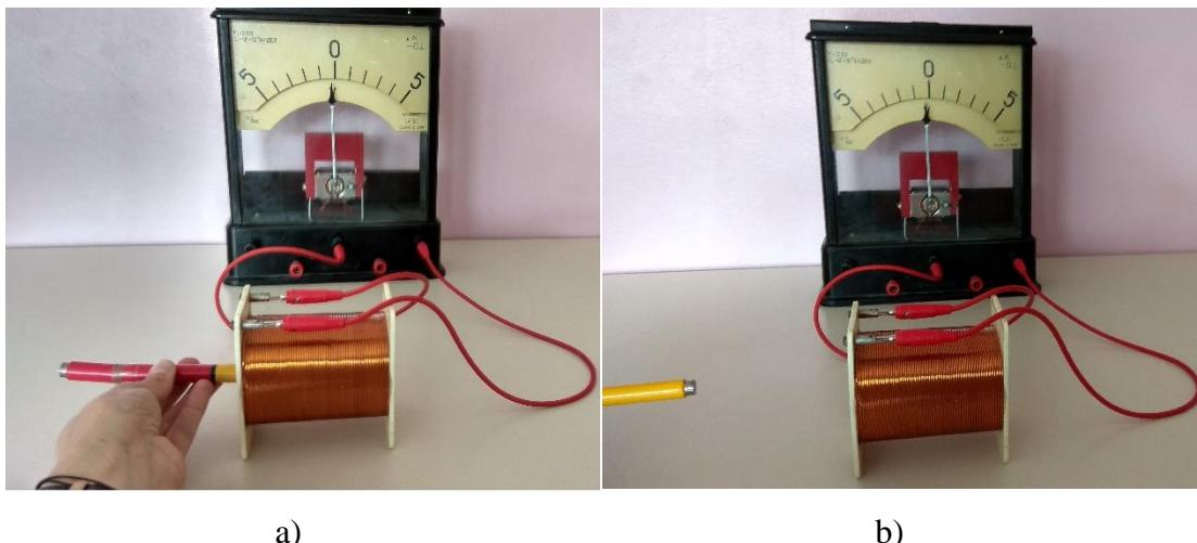
*Slika 3.11. Kazaljka galvanometra se ne otklanja ako a) magnet miruje unutar zavojnice b) magnet miruje izvan zavojnice*
