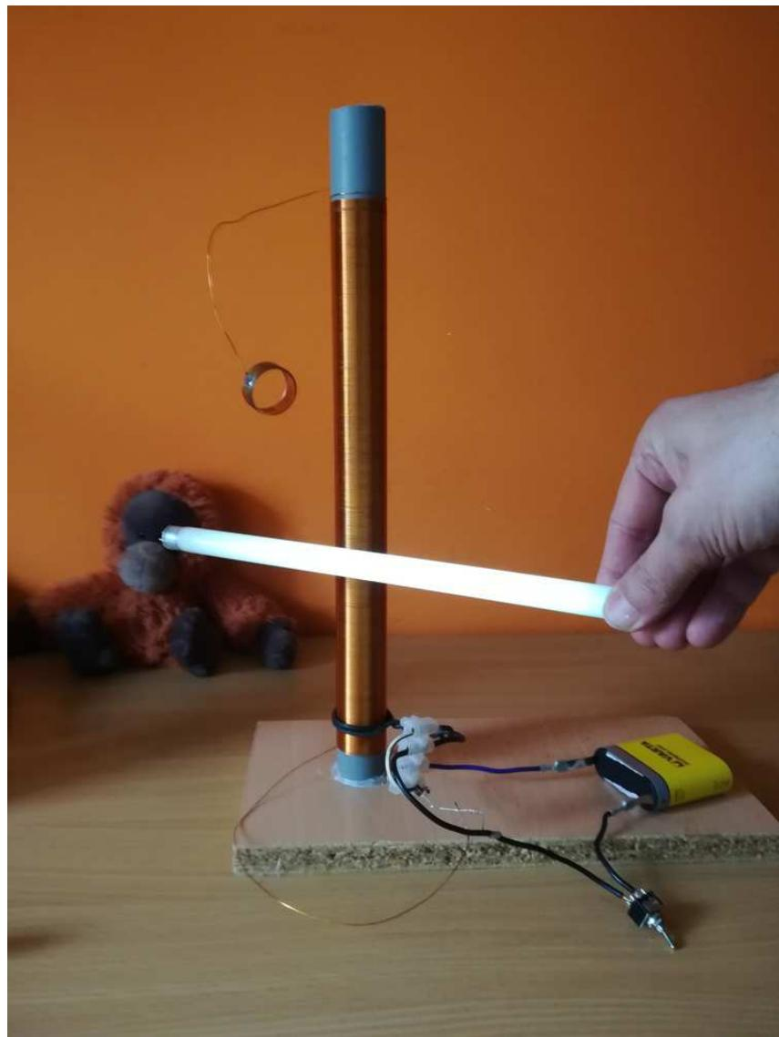
Slika 5.19: Neonska žarulja svijetli pomoću Teslinog transformatora
