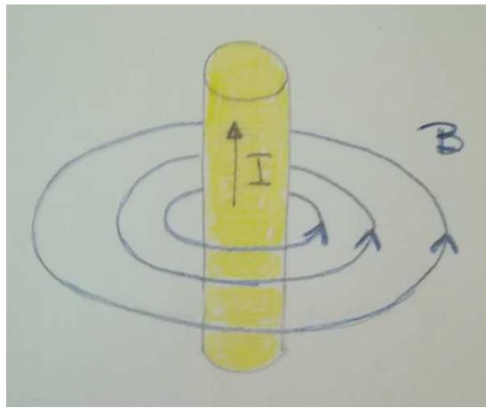
Slika 5.13: Silnice magnetskog polja oko dugog, ravnog vodiča
