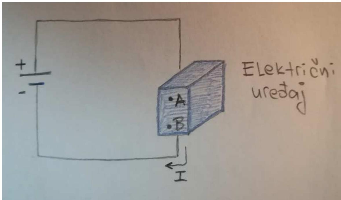
Slika 4.1: Struja I donosi energiju električnom uređaju
