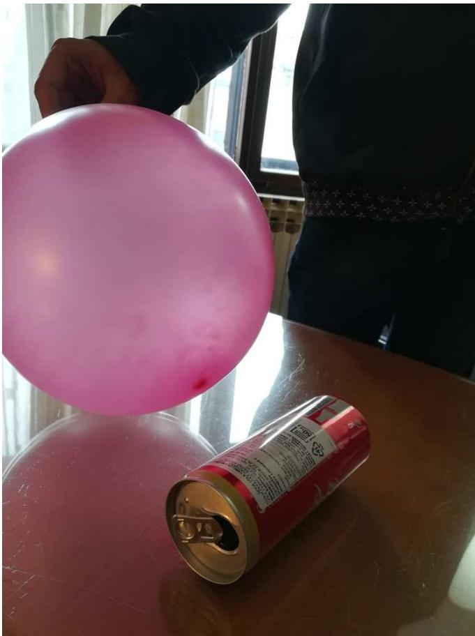
Slika 5.7: Kotrljanje limenke pomoću električki nabijenog balona
