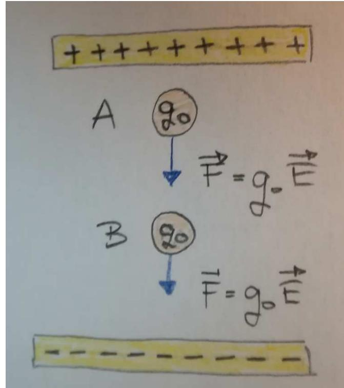
Slika 3.2: Električna sila je izvršila rad na naboju  $q_0$  koji se kreće od A do B
