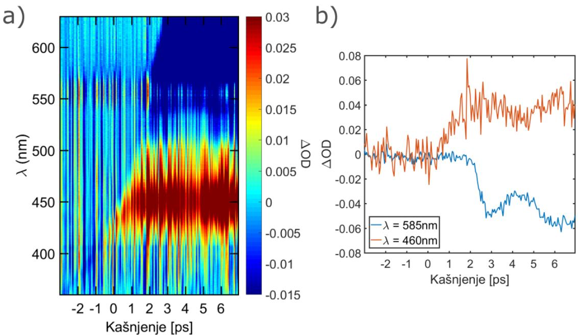
Slika 7.6: a) Tranzijentna apsorpcija rodamin B molekula otopljenih u acetonitrilu. b) Ovisnost signala o kašnjenu za valne duljine 460nm i 585nm. Transmitivnost pripravljene otopine iznosi 0.25 na valnoj duljini pumpe (267nm).
