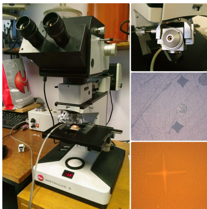
Slika 1.2. Slika uređaja (mikroskop i dijamantni indentor) za određivanje Vickersove mikrotvrdoće sa primjerima indentacija na uzorku.
