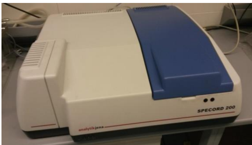
Slika 2. UV/VIS spektrofotometar SPECORD 200 Analytik-JENA, De
