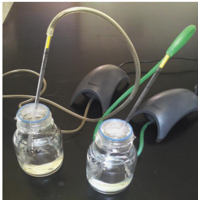
Slika 4: Priprema Schottovih boca za inkubaciju sa aeracijom, upuhivanje zraka u boce
