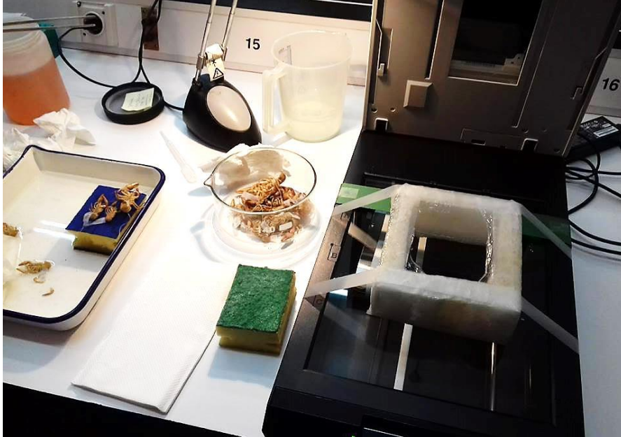
Slika 15. Skeniranje rakova s pripremljenim „bazenom“ na skeneru u svrhu geometrijsko morfometrijskih analiza.
