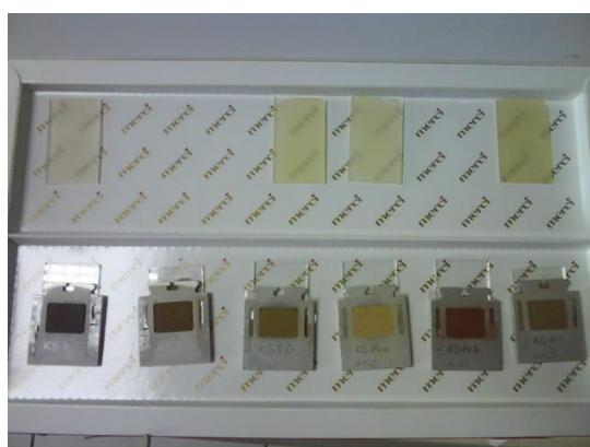
Slika 2.11: Uzorci pripremljeni za rendgensku difrakciju na prahu.
