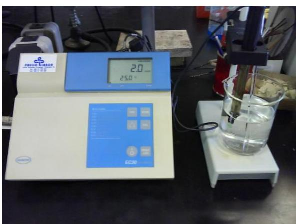
Slika 2.8: Stolni laboratorijski pH metar BT-675.
