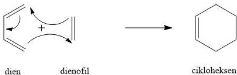
Slika 12. Općeniti mehanizam Diels-Alderova reakcije sa alkenom kao dienofilom
