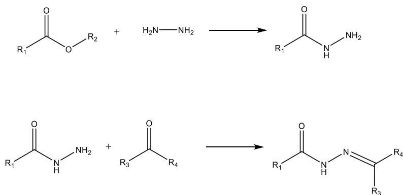
Slika 4. Shematski prikaz sinteze hidrazona<sup>15</sup>
