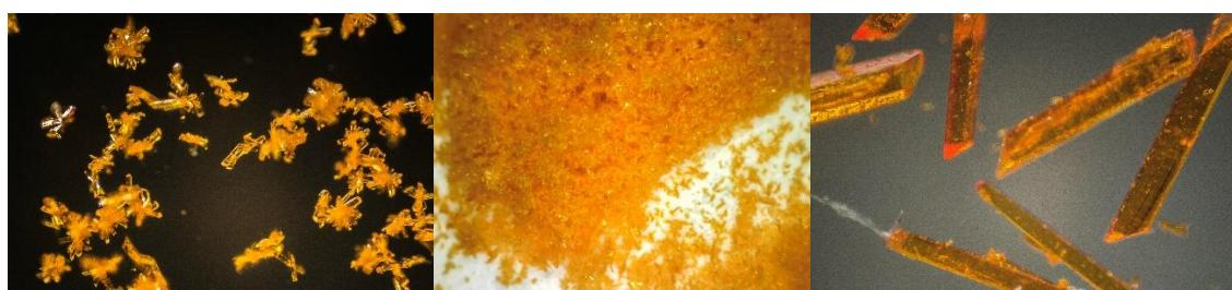
Slika 18. Produkti reakcija [MoO<sub>2</sub>(acac)<sub>2</sub>] s H<sub>2</sub>4–OMeSalHB u metanolu na sobnoj temperaturi (lijevo), pri temperaturi vrenja reakcijske smjese (u sredini) i pri uvjetima solvotermalne sinteze (desno)
