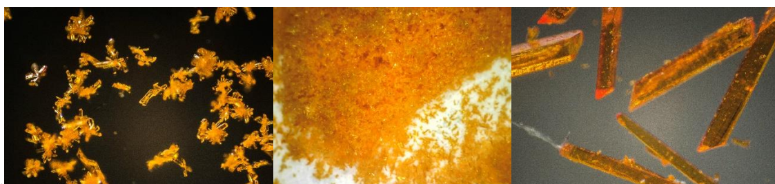
Slika 18. Produkti reakcija [\text{MoO}_2(\text{acac})_2] s \text{H}_2\text{4-OMeSalHB} u metanolu na sobnoj temperaturi (lijevo), pri temperaturi vrenja reakcijske smjese (u sredini) i pri uvjetima solvotermalne sinteze (desno)
