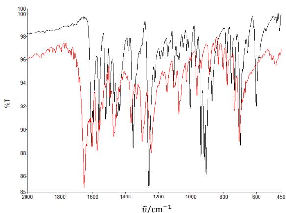
Slika 19. Usporedba infracrvenog spektra produkta reakcije  $[\text{MoO}_2(\text{acac})_2]$  s ligandom  $\text{H}_2\text{VanHB}$  u metanolu (crno) sa spektrom liganda  $\text{H}_2\text{VanHB}$  (crveno) u području valnih brojeva od  $2000$  do  $450 \text{ cm}^{-1}$
