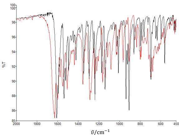
Slika 19. Usporedba infracrvenog spektra produkta reakcije  $[\text{MoO}_2(\text{acac})_2]$  s ligandom  $\text{H}_24\text{-OMeSalHB}$  u metanolu (crno) sa spektrom liganda  $\text{H}_24\text{-OMeSalHB}$  (crveno) u području valnih brojeva od  $2000$  do  $450 \text{ cm}^{-1}$
