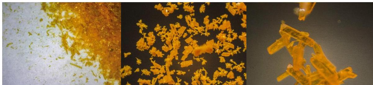
Slika 15. Produkt reakcije [MoO<sub>2</sub>(acac)<sub>2</sub>] s H<sub>2</sub>SalHB u metanolu pri sobnoj temperaturi (lijevo), uz zagrijavanje (u sredini) i pri uvjetima solvothermalne sinteze (desno)
