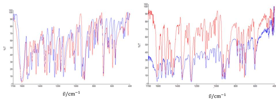
Slika 29. Usporedba infracrvenih spektra produkta reakcija  $[\text{MoO}_2(\text{acac})_2]$  s ligandima  $\text{H}_2\text{SalHB}$  (lijevo) i  $\text{H}_2\text{VanHB}$  (desno) u metanolu uz dodatak i bez dodatka piridina u rasponu od  $1700 \text{ cm}^{-1}$  do  $450 \text{ cm}^{-1}$ . Spektri kompleksa  $[\text{MoO}_2(\text{L})(\text{MeOH})]$  prikazani su plavom bojom, a kompleksa  $[\text{MoO}_2(\text{L})\text{py}]$  crvenom bojom.
