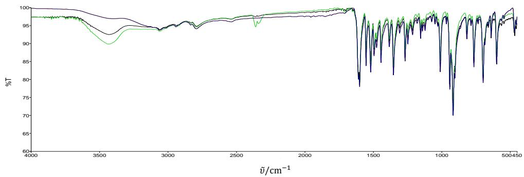
Dodatak 7. Usporedba infracrvenih spektara produkata reakcije  $[\text{MoO}_2(\text{acac})_2]$  i  $\text{H}_2\text{OMeSalHB}$  u metanolu: na sobnoj temperaturi (zeleno), na povišenoj temperaturi (plavo), te u uvjetima solvothermalne sinteze na  $110^\circ\text{C}$  (crno) i  $150^\circ\text{C}$  (crveno)
