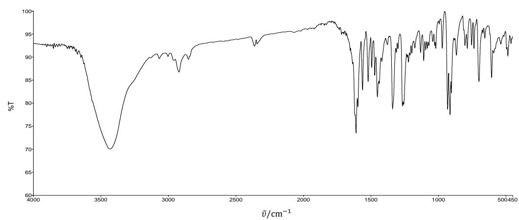
Dodatak 12. Infracrveni spektar produkta reakcije  $[\text{MoO}_2(\text{acac})_2]$  s  $\text{H}_2\text{SalHB}$  u metanolu uz dodatak piridina
