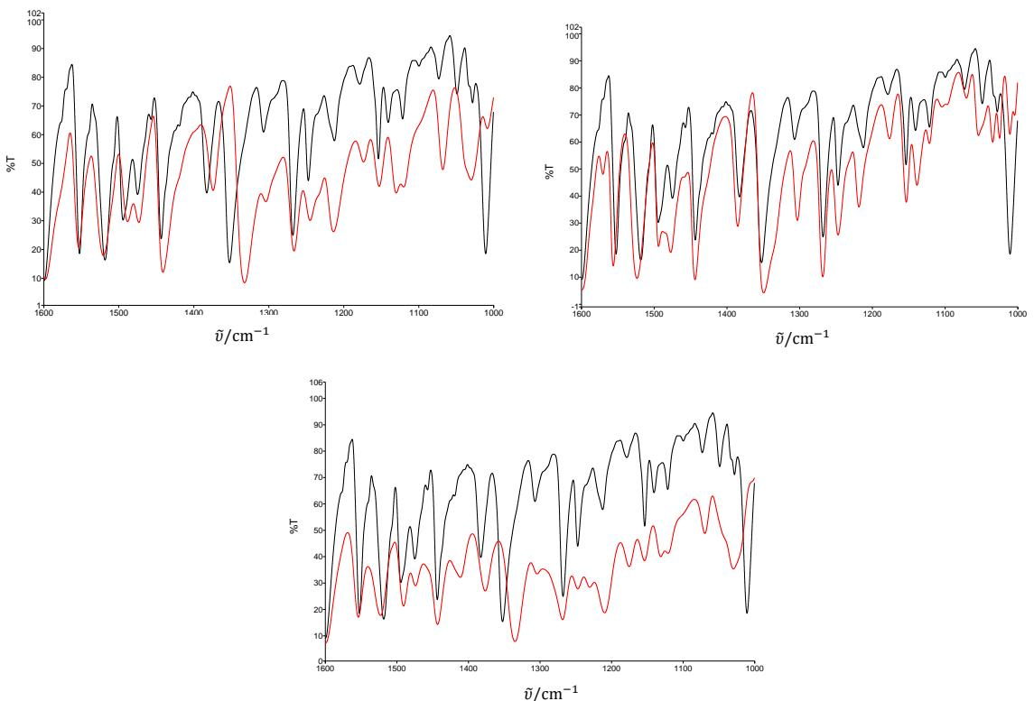
Slika 29. Preklapanje infracrvenog spektra kompleksa  $[\text{MoO}_2(\text{SalHB})(\text{MeOH})]$  s produkтом dobivenim otapanjem u piridinu (gore lijevo),  $\alpha$ -pikolina (gore desno) i  $\gamma$ -pikolina (dolje) u području valnih brojeva od  $1600$  do  $1000 \text{ cm}^{-1}$ . Spektri produkata prikazani su crvenom bojom
