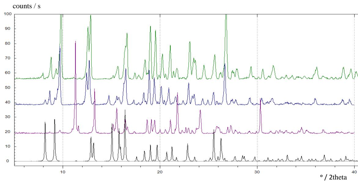
Dodatak 48. Usporedba difraktograma praškastih uzoraka produkata izlaganja kompleksa  $[\text{MoO}_2(\text{VanHB})(\text{MeOH})]$  parama alkohola: EtOH (crveno),  $n$ -PrOH (plavo),  $n$ -BuOH (svjetlo zeleno) i  $t$ -BuOH (tamno zeleno). Difraktogram polaznog kompleksa prikazan je crnom bojom.
