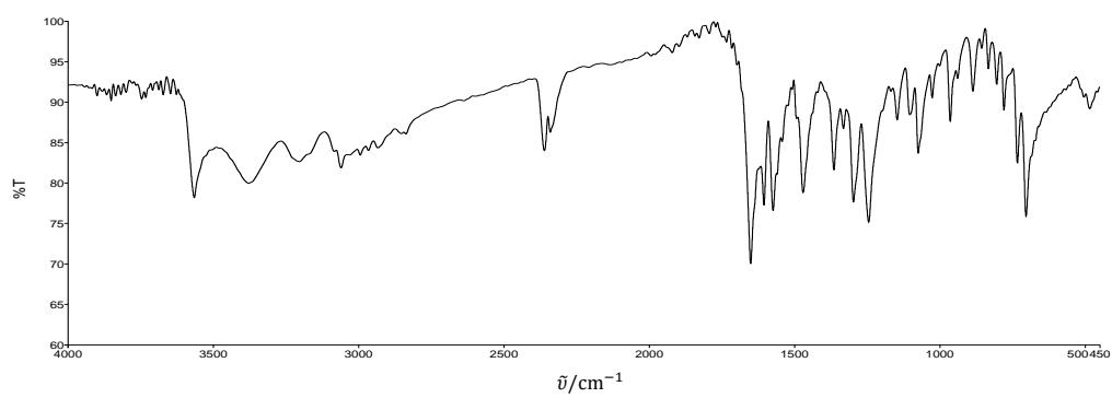
Dodatak 6. Infracrveni spektri produkata reakcije  $[\text{MoO}_2(\text{acac})_2]$  i  $\text{H}_2\text{SalHB}$  u metanolu: na sobnoj temperaturi (plavo), pri temperaturi vrenja reakcijske smjese (crno) i u uvjetima solvothermalne sinteze (zeleno)
