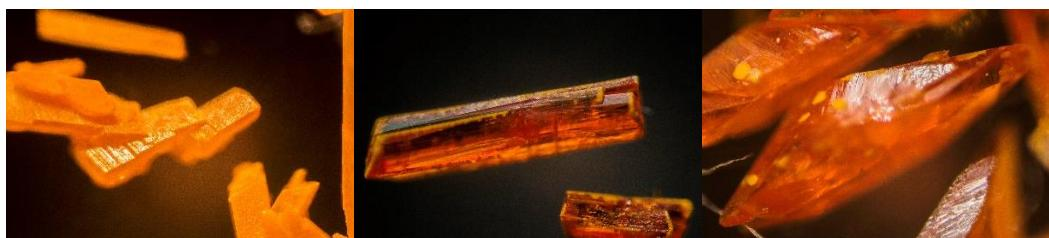
Slika 27. Proizvodi reakcije  $[\text{MoO}_2(\text{acac})_2]$  u metanolu uz dodatak piridina s:  $\text{H}_2\text{SalHB}$  (lijevo),  $\text{H}_24-\text{OMeSalHB}$  (u sredini) i  $\text{H}_2\text{VanHB}$  (desno)
