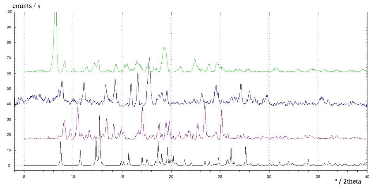
Dodatak 39. Usporedba difraktograma praškastih uzoraka produkata izlaganja kompleksa  $[\text{MoO}_2(\text{SalHB})(\text{MeOH})]$  parama alkohola: EtOH (crveno),  $n$ -PrOH (plavo),  $n$ -BuOH (svjetlo zeleno) i  $t$ -BuOH (tamno zeleno). Difraktogram polaznog kompleksa prikazan je crnom bojom.
