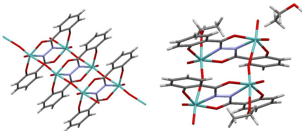
Slika 8. Prikaz molekulske strukture kompleksa  $[(\text{MoO}_2)_2\text{L}]_n$  (lijevo) i  $\{(\text{C}_2\text{H}_5\text{OH})\text{LO}_3\text{Mo}_2\}_2(\mu-\text{O})_2 \cdot \text{C}_2\text{H}_5\text{OH}$  (desno),  $\text{L} = N,N'$ -disaliciloilhidrazin<sup>23</sup>
