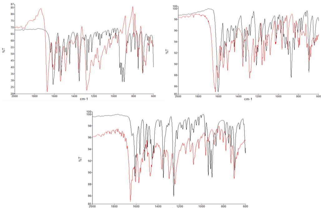
Slika 26. Preklapanje infracrvenih spektara liganda (crveno) i produkta reakcije  $[\text{MoO}_2(\text{acac})_2]$ s ligandom u acetonitrilu (crno):  $\text{H}_2\text{SalHB}$  (gore lijevo),  $\text{H}_2\text{4-OMeSalHB}$  (gore desno) i  $\text{H}_2\text{VanHB}$  (dolje)
