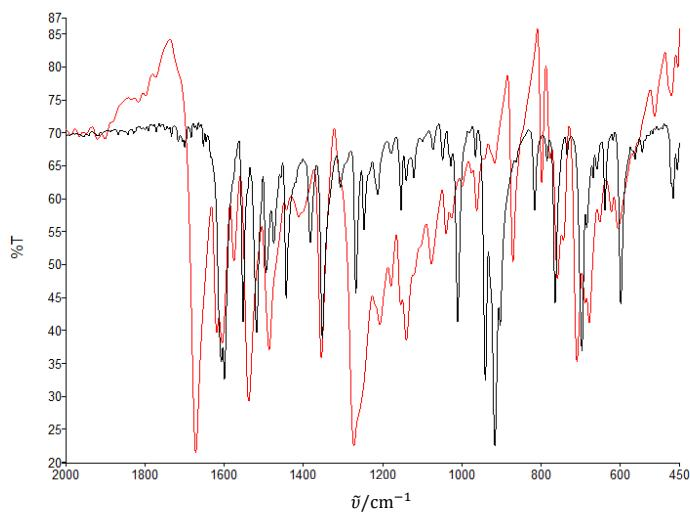
Slika 16. Preklapanje infracrvenog spektra produkta reakcije  $[\text{MoO}_2(\text{acac})_2]$  i  $\text{H}_2\text{SalHB}$  u metanolu (crno) s infracrvenim spektrom liganda  $\text{H}_2\text{SalHB}$  (crveno) u području valnih brojeva od  $2000$  do  $450 \text{ cm}^{-1}$
