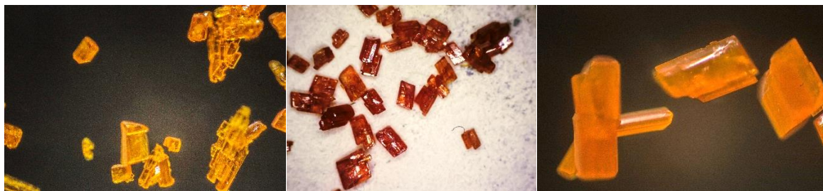
Slika 20. Produkti reakcije [\text{MoO}_2(\text{acac})_2] i VanHB: pri sobnoj temperaturi (lijevo), pri povišenoj temperaturi (u sredini) i pri uvjetima solvotermalne sinteze (desno)
