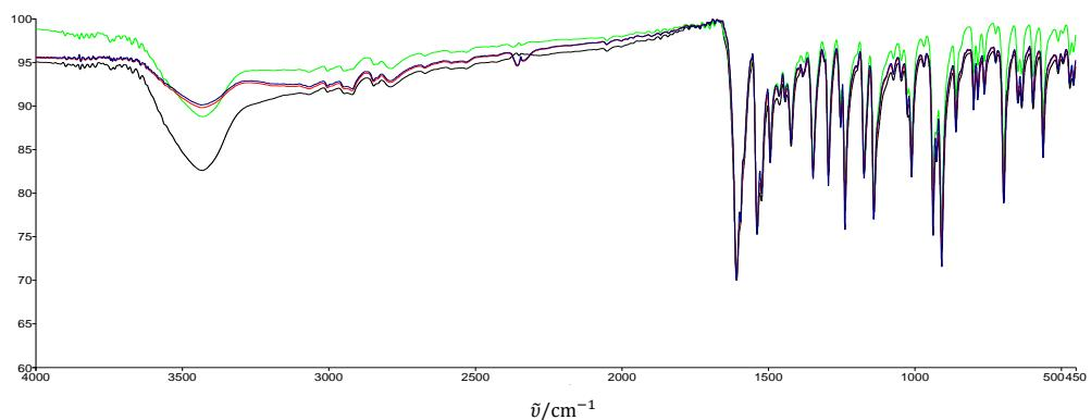
Dodatak 8. Usporedba infracrvenih spektara produkata reakcije  $[\text{MoO}_2(\text{acac})_2]$  i VanHB u metanolu: na sobnoj temperaturi (zeleno), na povišenoj temperaturi (plavo), te u uvjetima solvothermalne sinteze na  $110^\circ\text{C}$  (crno) i  $150^\circ\text{C}$  (crveno)
