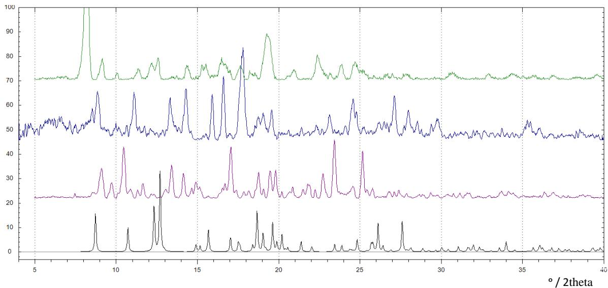
Dodatak 41. Usporedba difraktograma praškastih uzoraka produkata otapanja kompleksa  $[MoO_2(4-\text{OMeSalHB})(\text{MeOH})]$  u alkoholima: EtOH (crveno),  $n$ -PrOH (plavo),  $n$ -BuOH (svjetlo zeleno) i  $t$ -BuOH (tamno zeleno). Difraktogram polaznog kompleksa prikazan je crnom bojom.
