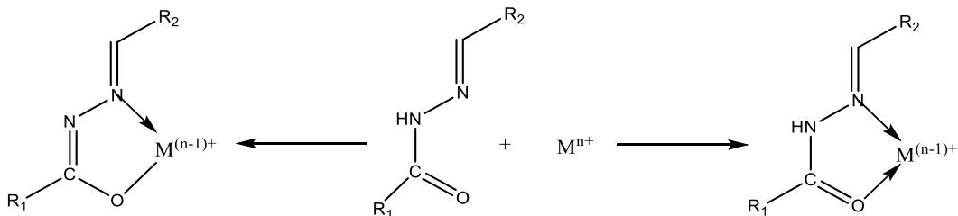
Slika 6. Načini vezanja hidrazona na metalni centar: enoliminska forma (lijevo) i ketoamino forma (desno)<sup>16</sup>
