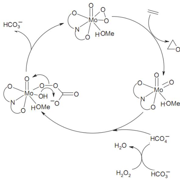
Slika 11. Prepostavljeni mehanizam epoksidacije olefina uz  $[\text{MoO}_2\text{L}(\text{CH}_3\text{OH})]$  kao katalizator i natrijev hidrogenkarbonat kako kokatalizator<sup>28</sup>
