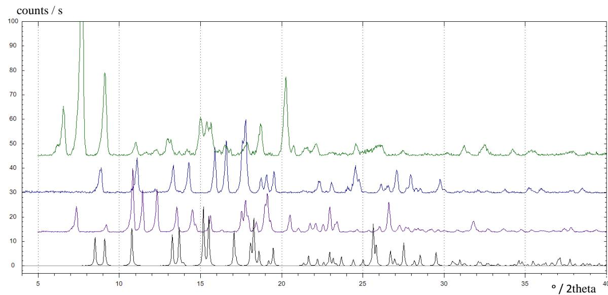
Dodatak 43. Usporedba difraktograma praškastih uzoraka produkata izlaganja kompleksa  $[MoO_2(4-\text{OMeSalHB})(\text{MeOH})]$  parama alkohola: EtOH (crveno),  $n$ -PrOH (plavo),  $n$ -BuOH (svjetlo zeleno) i  $t$ -BuOH (tamno zeleno). Difraktogram polaznog kompleksa prikazan je crnom bojom.
