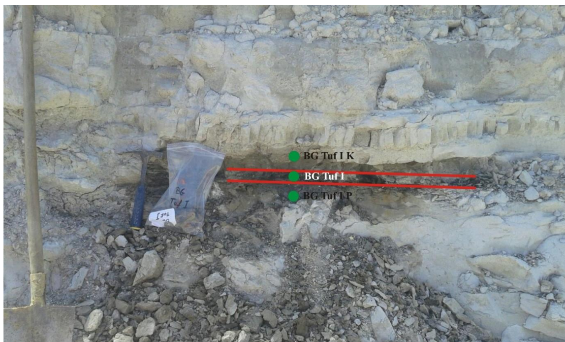
Slika 3. Prvi sloj tufa (istaknut crvenim linijama) na kopu Bukova glava. Zelene točke označavaju mjesta uzorkovanja s pripadajućim oznakama uzoraka. Mjerilo – geološki čekić (25 cm) (foto Frane Marković).
