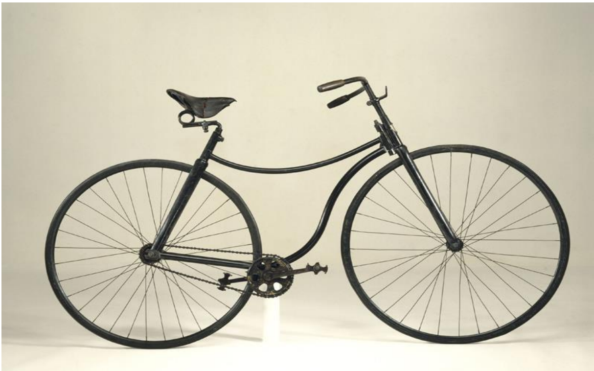
Slika 1. Preteča modernog bicikla prema Starleyevom modelu
