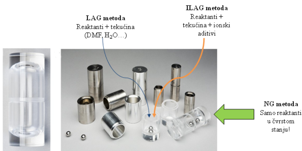
Slika 5. Prikaz reakcijskih posudica i metoda koji se koriste u mehanokemijskim reakcijama.
