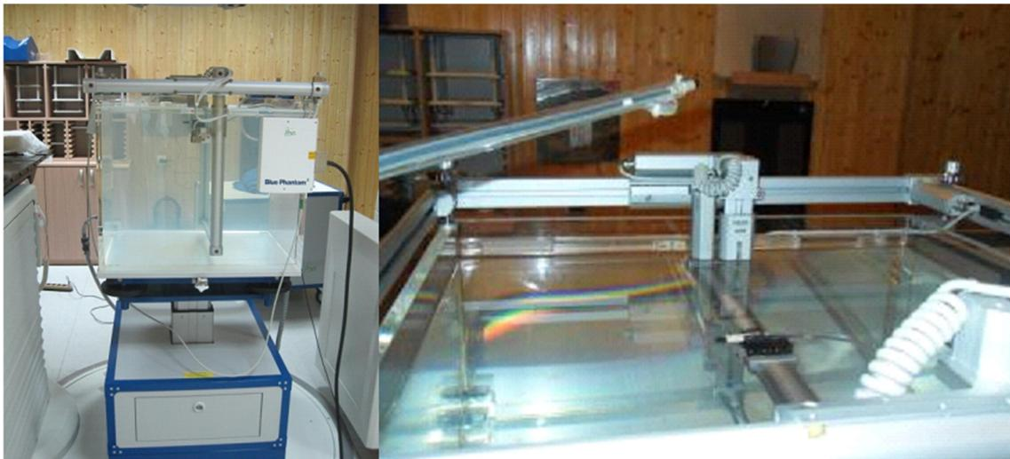
Slika 3.7. Voden fantom IBA Blue<sup>2</sup> s ionizacijskim komorama malih volumena u mjernom postavu.
