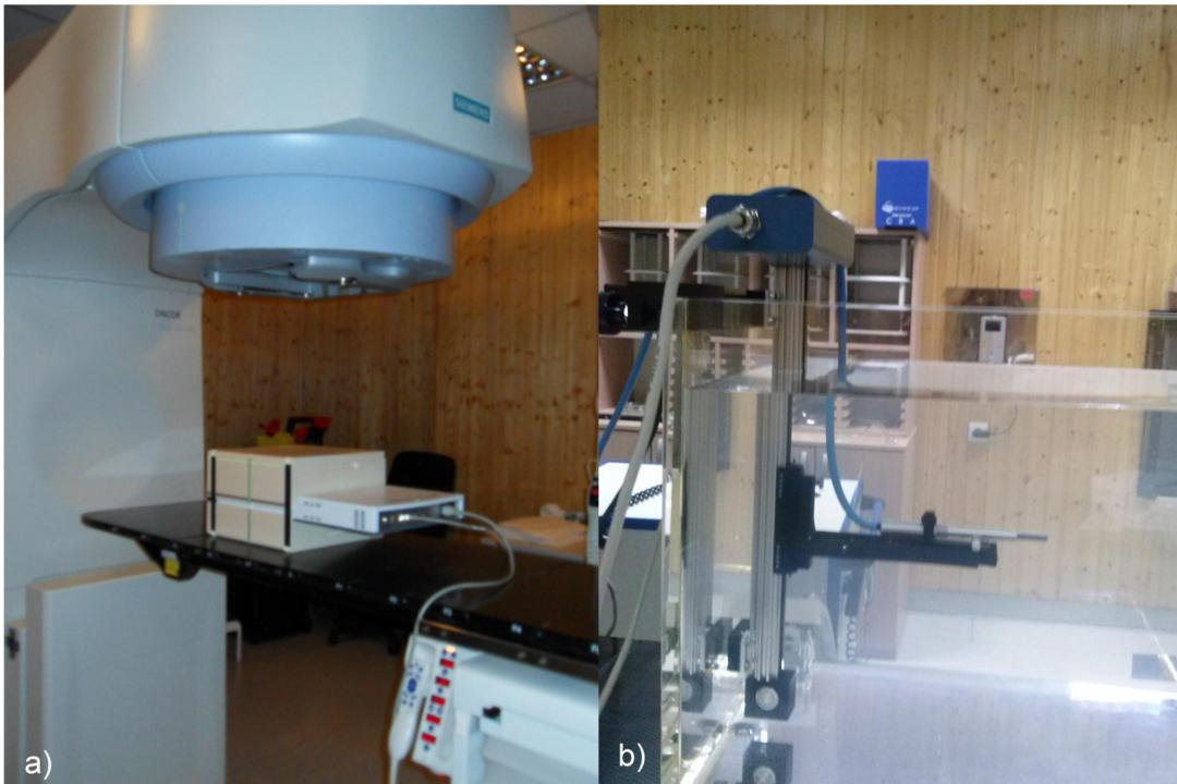
Slika 3.5. Postav određivanja faktora popravke  $k_k$ : a) mjerjenje 2D detektorom I'mRT MatriXX; b) mjerjenje ionizacijskom komorom u vodi na istoj dubini kao što su komore 2D detektora s fantomom MultiCubom.
