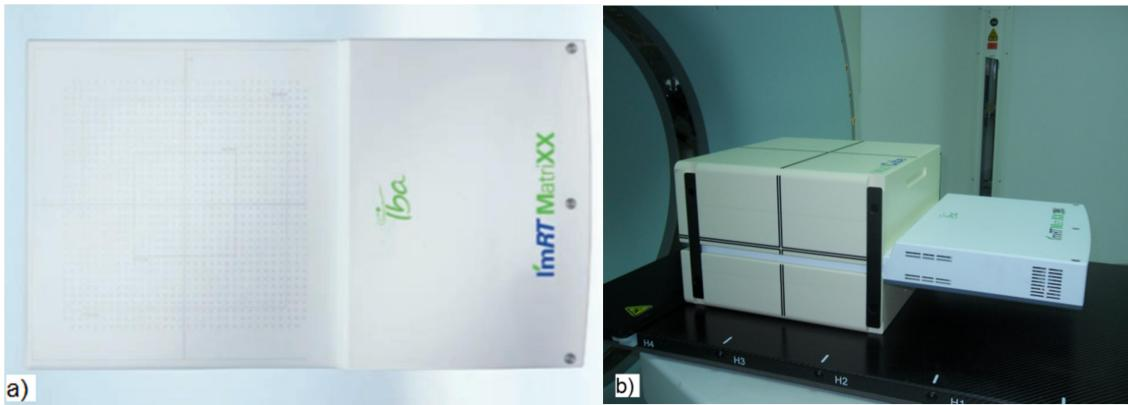
Slika 3.4.a) Dvodimenzionalni detektor I'mRT MatriXX, b) I'mRT MatriXX s fantomom IBA MultiCube.
