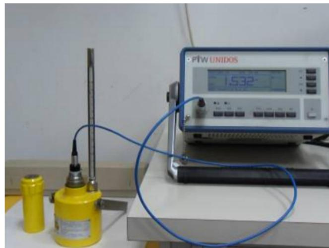
Slika 3.14. Postav za ispitivanje stabilnosti dozimetrijskog sustava koristeći radioaktivni izvor Sr-90.
