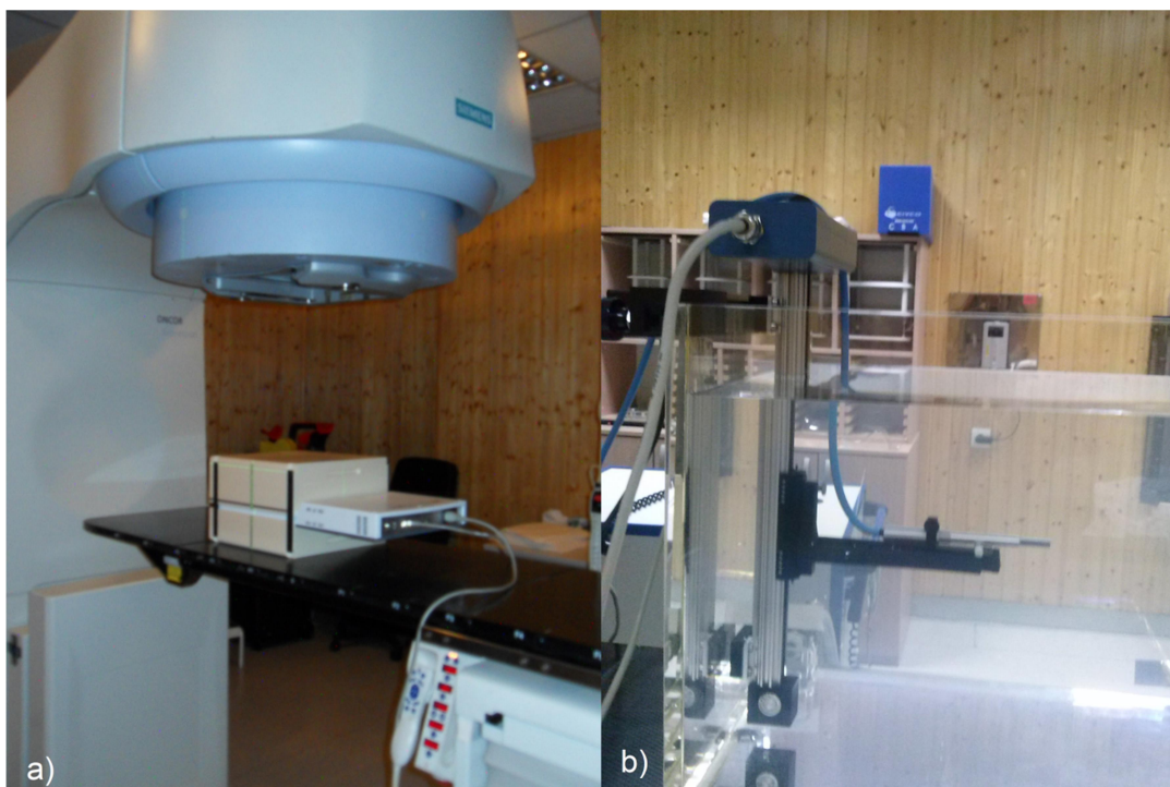
Slika 3.5. Postav određivanja faktora popravke k_k : a) mjerenje 2D detektorom ImRT MatriXX; b) mjerenje ionizacijskom komorom u vodi na istoj dubini kao što su komore 2D detektora s fantomom MultiCubom.
