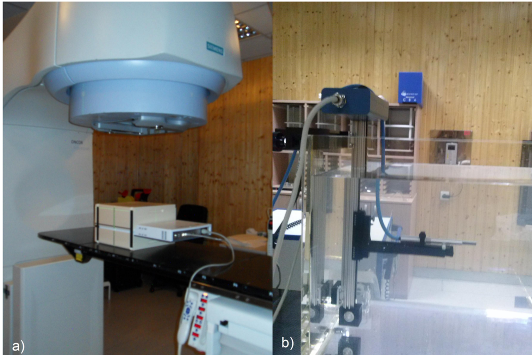
Slika 3.5. Postav određivanja faktora popravke k_r : a) mjerjenje 2D detektorom ImRT MatriXX; b) mjerjenje ionizacijskom komorom u vodi na istoj dubini kao što su komore 2D detektora s fantomom MultiCubom.
