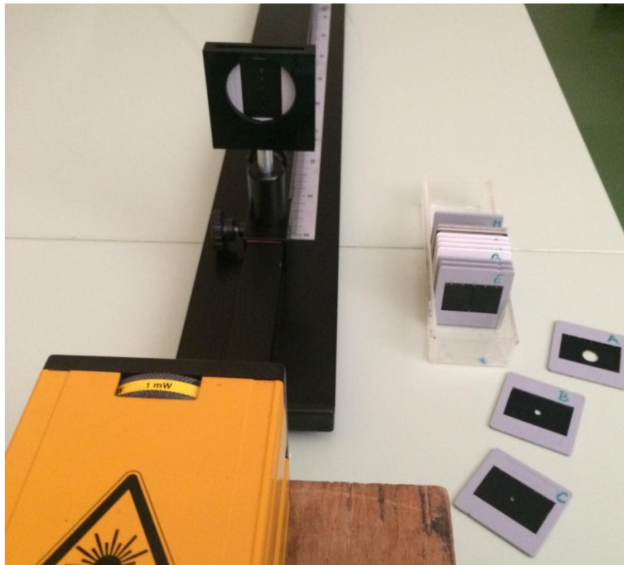
Slika 3.6: Postav za promatranje ogiba svjetlosti na pukotini
