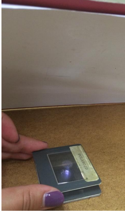
Slika 3.16: Polaroidi su postavljeni okomito
