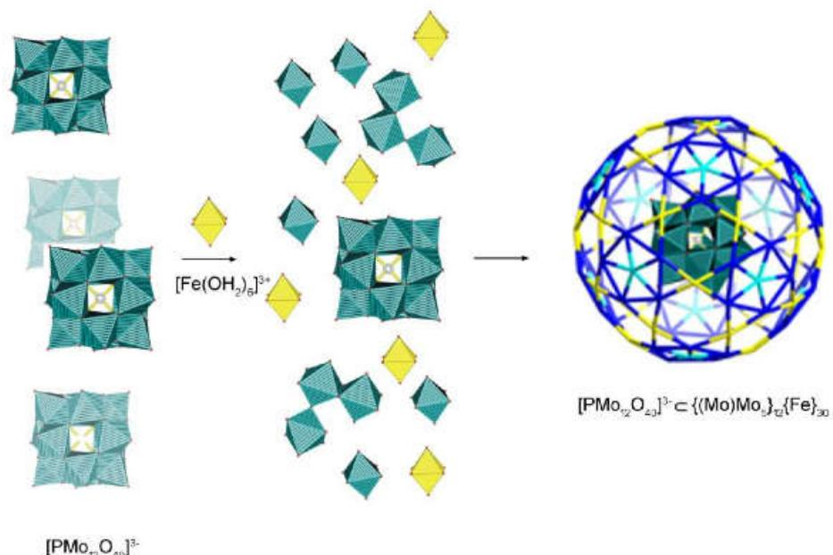
Slika 4. Prikaz reakcije Kegginovih iona (zeleni poliedri) s  $[\text{Fe}(\text{H}_2\text{O})_6]^{3+}$  ionima (žuti poliedri). Konačni spoj je klaster, koji u svome središtu sadrži nerazloženi Keggin anion.
