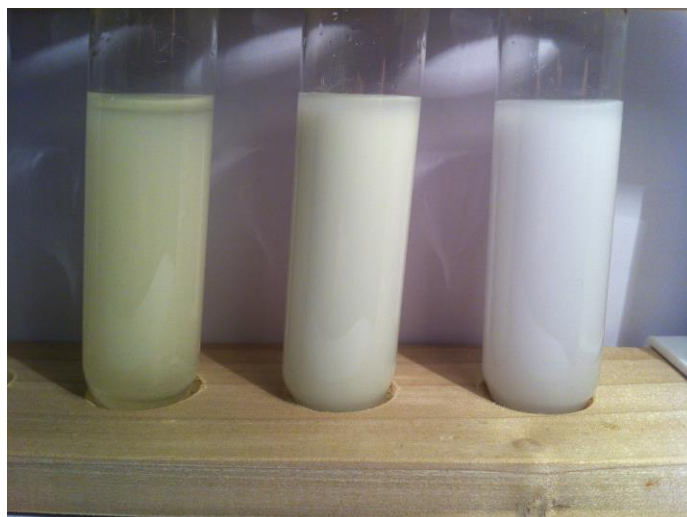
Slika 3. Talozi srebrovih halogenida, AgI, AgBr, AgCl (s lijeva na desno) 9
