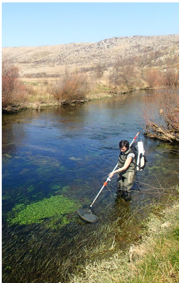
Slika 4.1. Provođenje elektroribolova lednim agregatom na rijeci Čikoli. (Foto: M. Košutić)
