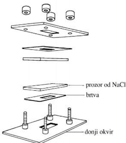
Slika 2.6. Metalni nosač i pločice natrijeva klorida za snimanje tekućih uzoraka.<sup>5</sup>
