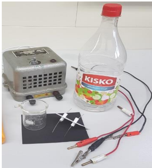
Slika M4. Pribor i kemikalije potrebni za provedbu elektrolize prema TVRDNJI 4.
