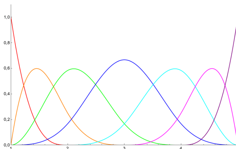
Slika 8. Niz B-spline funkcija ( k = 4 ) dobivenih podjelom intervala [1, 5] nizom čvorova (1, 2, 3, 4, 5) .
