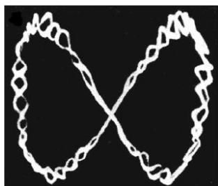
Slika 12. Fotografija putanje iona nabijenih čestica aluminija u trodimenzijskoj ionskoj stupici. 1
