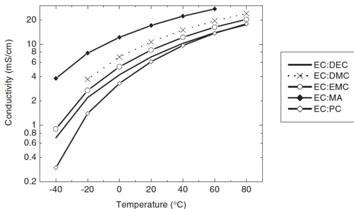
Slika 25: Ovisnost vodljivosti elektrolita o temperaturi za razne binarne mješavine otapala [1]
