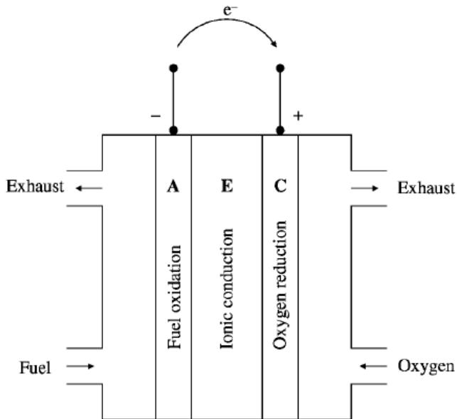
Slika 34: Princip rada gorive čelije [8 ]
