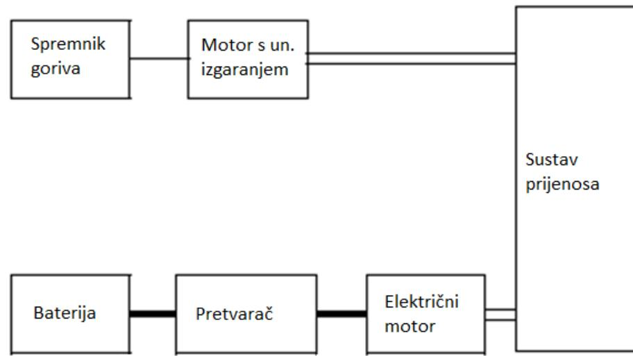
Slika 3: Shematski prikaz ključnih komponenti paralelnog hibridnog vozila [6]
