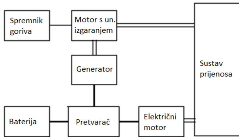
Slika 4: Shematski prikaz komponenti serijsko - paralelnog hibridnog vozila [6]
