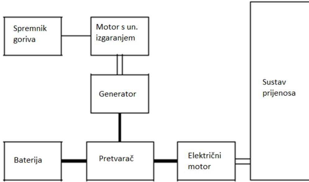
Slika 2:Shematski prikaz ključnih komponenti serijskog hibridnog vozila [6]
