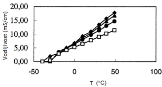
Slika 24: Ovisnost vodljivosti o temperaturi za različite koncentracije soli u otapalu; kvadrati označavaju 0.4 M  $\text{LiPF}_6$ , krugovi 0.6 M  $\text{LiPF}_6$ , trokuti 0.8 M  $\text{LiPF}_6$  te rombovi 1 M  $\text{LiPF}_6$  [14].
