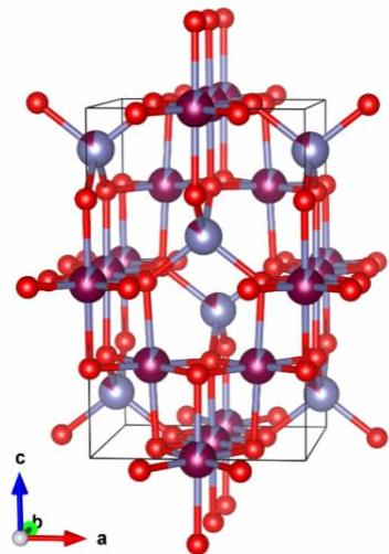
Slika 30: Jedinična čelija materijala spinelne strukture u tetragonskom sustavu [48]
