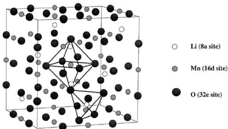
Slika 19: Jedinična čelija materijala normalne spinele strukture [14]
