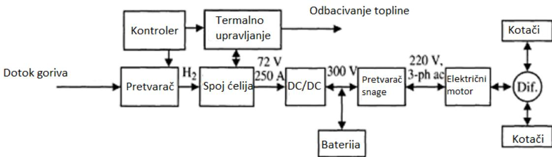
*Slika 5:* Shematski prikaz komponenti vozila na gorive čelije[6]
