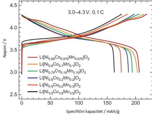
Slika 17: Punjenje/praznjenje litij - ionske baterije s katodom od  $\text{LiNi}_x\text{Mn}_y\text{Co}_z\text{O}_2$  za različite koncentracije pojedinih metala [9]
