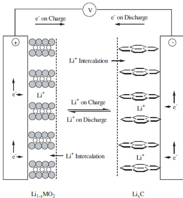
Slika 14: Princip rada litij - ionske baterije [1]
