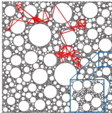
**Slika 3.9:** Putanja nasumičnog šetača. Zbog velike gustoće fluktuacija, materijal dozvoljava Lévyjev let (crvenom bojom). Plavom bojom je označen uvećani prikaz strukture materijala koji je invarijantna na skaliranje, odnosno posjeduje fraktalna svojstva. Preuzeto iz [9].
