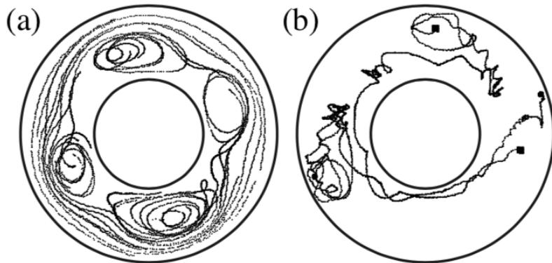
**Slika 3.7:** (a) prikazuje čestice koje se gibaju poput 4 vrtloga i strujanje tekućine u smjeru obrnutom od kazaljke na satu koja ih okružuje. Strujanje je prikazano iz sustava koji rotira zajedno s vrtlozima. (b) prikazuje dvije čestice u slabom strujanju tekućine pri kojem ne uočavamo dugoživuće koherentne strukture. Krajevi trajektorije jedne čestice označeni su krugovima, a druge kvadratima. Obje čestice se počinju gibati s desne strane. Preuzeto iz [8].
