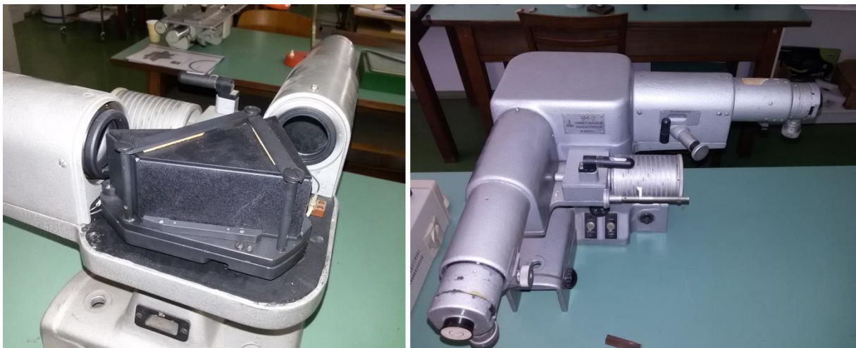
Slika 13: Ruski spektrometar UM-2 s Pellin Broca prizom.
