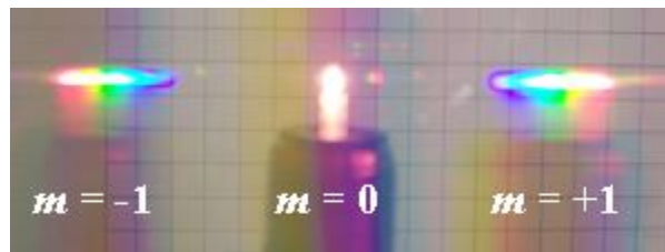
Slika 26: Prikazuje bijelu svjetlost promatranu kroz transmisijsku rešetku. Red m = 0 odgovara direktnoj transmisiji svjetlosti kroz rešetku. U prvom pozitivnom redu ( m = +1 ), boje s rastućim valnim duljinama (od plave do crvene boje) koje se difraktiraju pod rastućim kutovima. [10]
