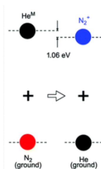
Slika 5.1: Penningova ionizacija metastabilnog atoma helija He^M s dušikom N_2 .
