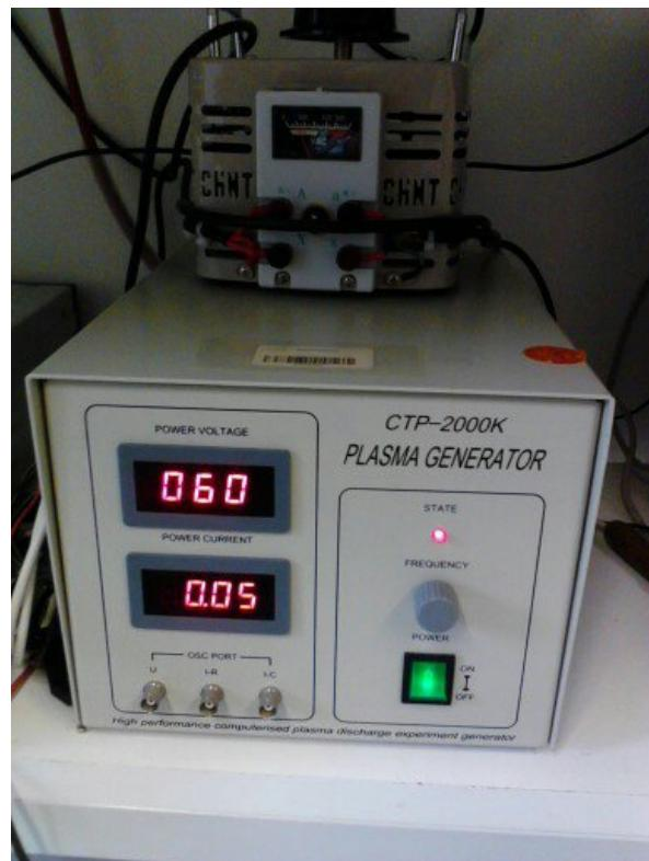
Slika 5.6: Izvor visokog napona i visoke frekvencije
