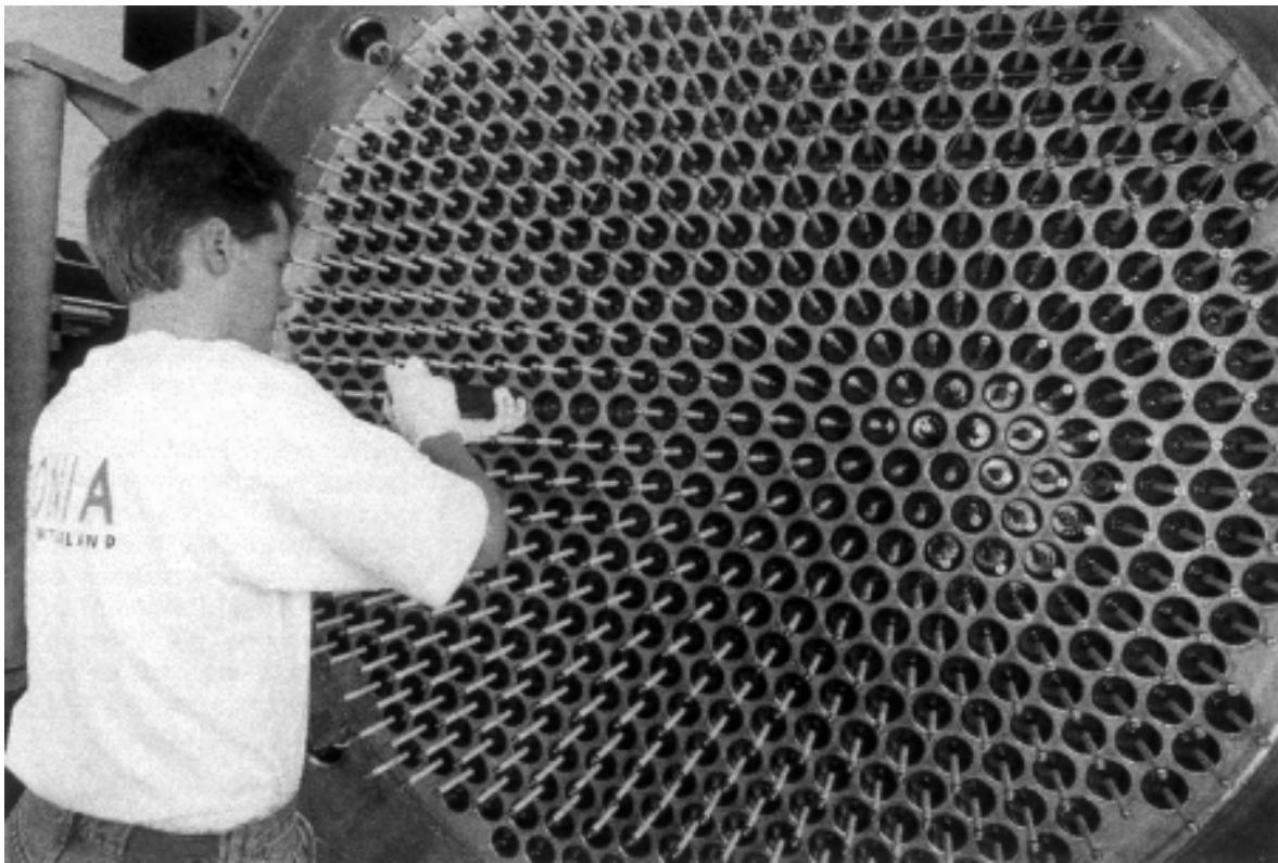
Slika 4.1: Pomoću dielektrika proizvodnja naprednih ozonizatora iznosi 60 kg/h
