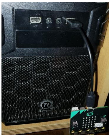
Slika 2.2.3. Spajanje micro:bit uređaja na računalo.
