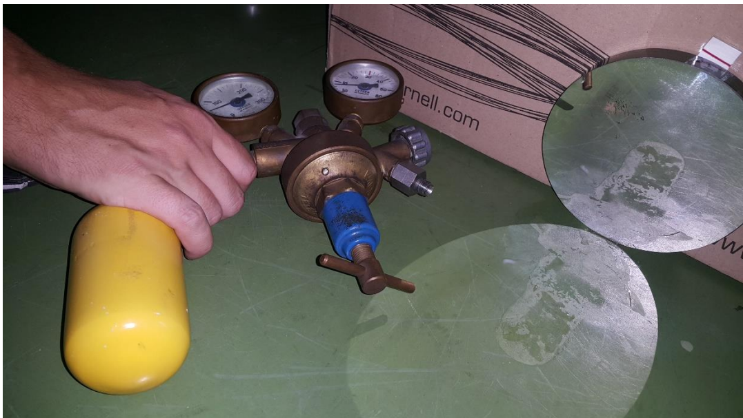
Slika 39. Puštanje helija iz boce pod tlakom (2).
