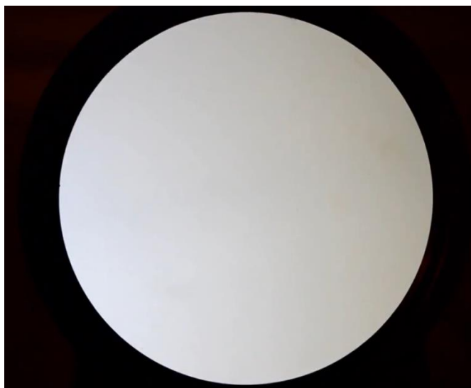
Slika 18. Uniformna distribucija svjetlosti na visokokvalitetnomu zrcalu [10].
