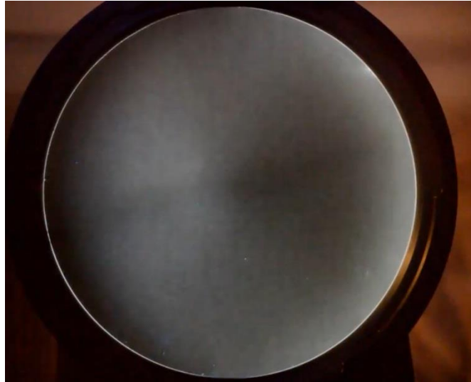
Slika 19. Uniformna distribucija svjetlosti na visokokvalitetnomu zrcalu s oštrim rubom kao preprekom [10].
