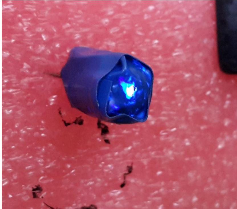
Slika 12. LED žarulja prekrivena izolacijskom ljepljivom trakom.
