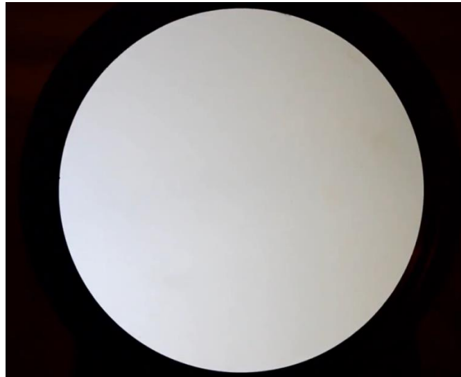
Slika 18. Uniformna distribucija svjetlosti na visokokvalitetnomu zrcalu [10].
