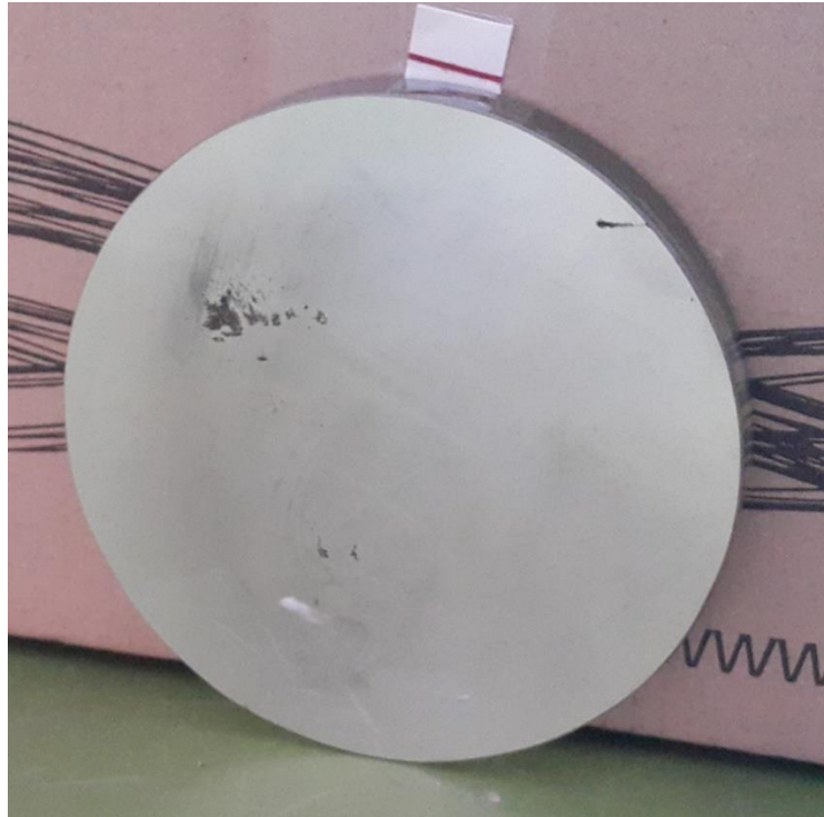
Slika 11. Parabolično zrcalo polumjera zakrivljenosti 2f = 128 cm. Vidljivo je malo oštećenje.
