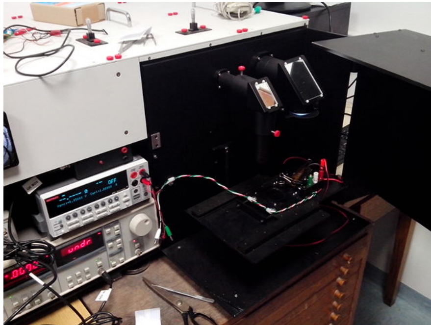
Slika 3.6: Eksperimentalni postav za mjerenje I-V karakteristike solarne ćelije.
