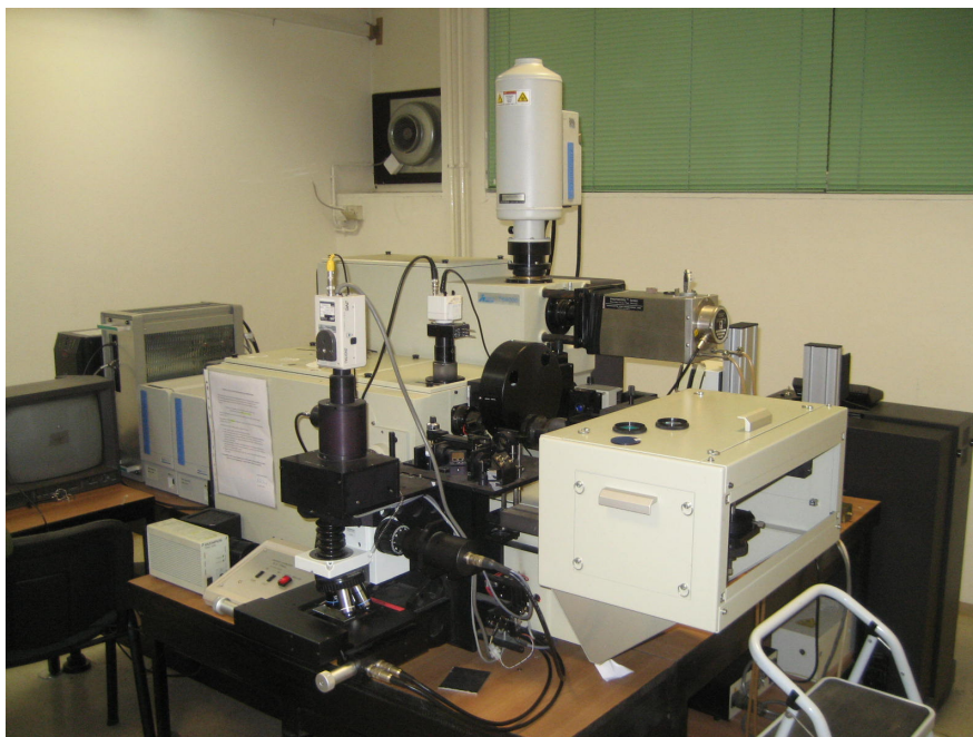
Slika 3.3: Ramanov spektrometar na Institutu Ruđer Bošković [27].
