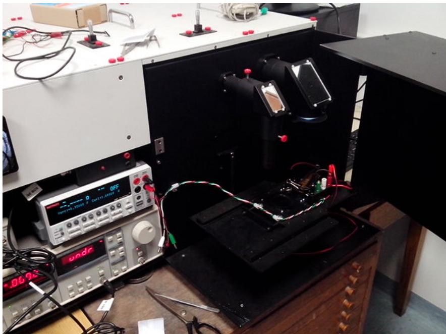
Slika 3.6: Eksperimentalni postav za mjerjenje I-V karakteristike solarne čelije.
