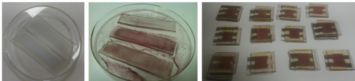
Slika 3.1: Lijevo:  $\text{TiO}_2$  slojevi naneseni na podloge FTO stakla, sredina:  $\text{TiO}_2$  slojevi nakon umakanja u N3 boju, desno: sastavljene DSSC.
