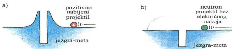
Zorna mehanička analogija za nalet neutrona-projektila na jezgru-metu prikazana je na slici b). Tada nema električnog odbijanja između neutrona-projektila i jezgre-mete pa nema vulkanskog brda oko jame. Zato projektil i sa sasvim malom energijom može doći do ruba jame i pasti u nju.
