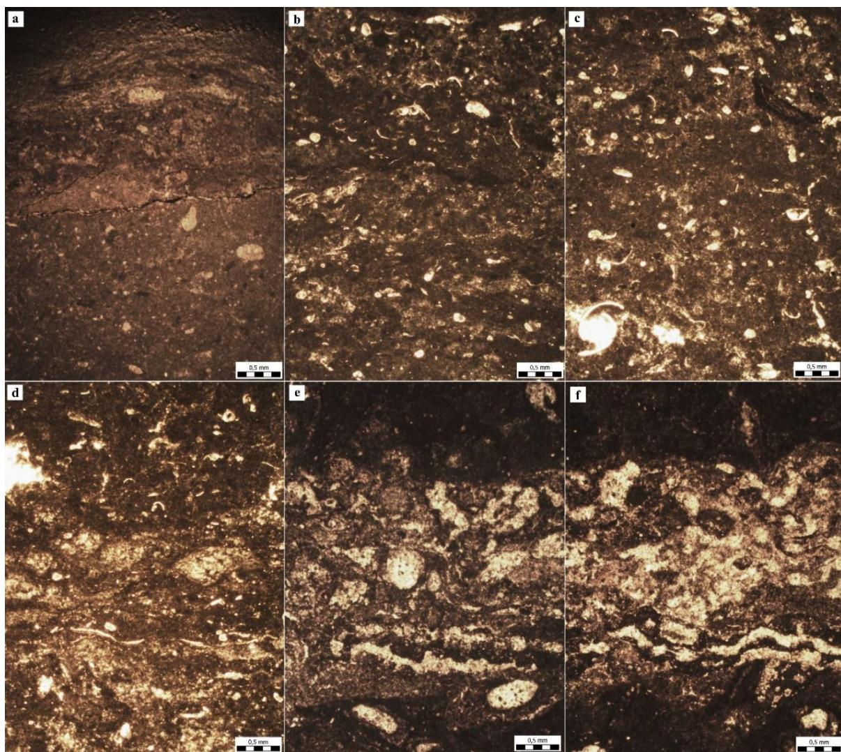
Slika 22 Fotomikrografije laminiranih kalkreta (uzorci BO-1). **a** Kontakt brečirane podlage s foraminiferama i crnim klastima i laminirane kalkrete sa šupljinama korijena koje su ispunjene sparitom. **b, c** Laminirane kalkrete s nakupinama peloida unutar lamina te ostacima ljuštura ostrakoda. **d, e, f** Laminirane kalkrete sa šupljinama korijena koje presijecaju lame.
