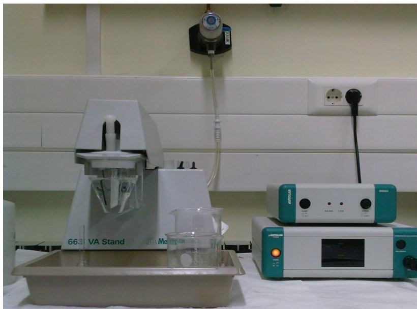
Slika 6. 663VA Stand troelektrodni sustav povezan s \mu AUTOLAB potencijostat/galvanostatom i IME jedinicom
