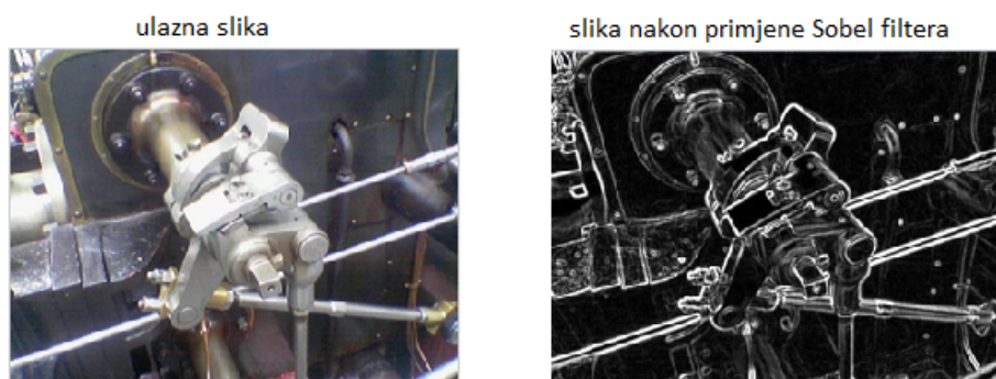
Slika 2.8: Originalna slika i slika nakon primjene Sobel filtera za detekciju rubova
