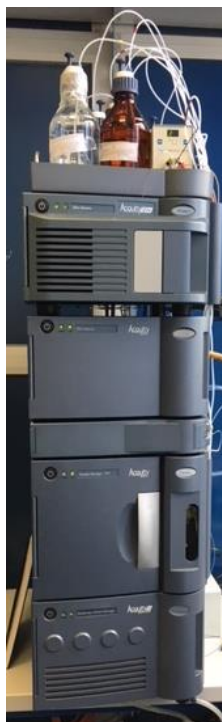
Slika 4. Prikaz korištenog tekućinskog kromatografa ultravisoke djelotvornosti (Acquity UPLC H-Class (Waters, SAD))
