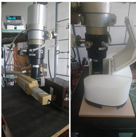
Slika 16. Lijevo je prikazana fotoliza polimernog uzorka 1,3–dinitrozobenzena, a desno praćenje kinetike polimerizacije 1,3–dinitrozobenzena u KBr pastili uz pomoć vremenski razlučene IR spektroskopije
