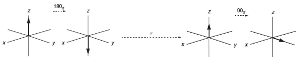
Slika 2.7. Shematski prikaz primijenjenih pulseva i vektora ukupne magnetizacije tijekom procesa inverznog oporavka. 34
