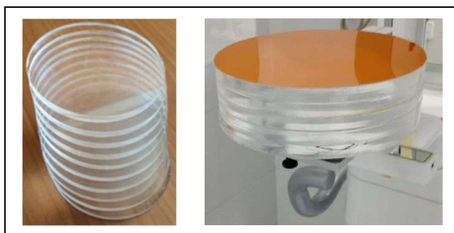
Slika 6. Dio fantoma korištenog za vrednovanje modela (lijevo) i radiokromski film koji se umetao među slojeve fantoma (desno).
