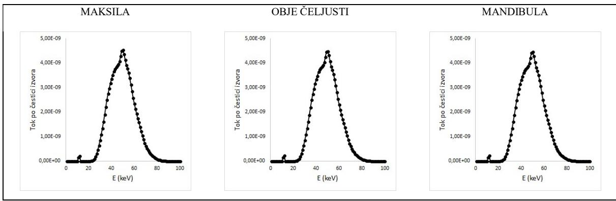
Slika 97. Energijski spektar fotonskog snopa u centru štitne žlijezde za simulirani CBCT uređaj pri naponu na rendgenskoj cijevi od 90 kV i kut rotacije rendgenske cijevi od  $180^\circ$  za različite položaje središta FOV-a veličine  $78 \times 78 \text{ mm}^2$
