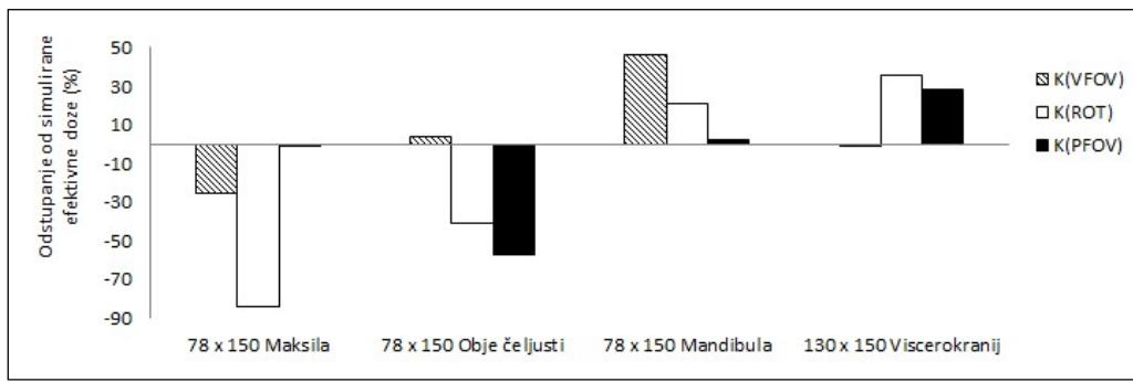
Slika 78. Odstupanja efektivne doze izračunate konverzijskim faktorima E/CBCTDI<sub>2</sub> danim za veličinu FOV-a (K(VFOV)), kut rotacije rendgenske cijevi (K(ROT)) i položaj FOV-a (K(PFOV)) od simulirane efektivne doze za sve simulirane kliničke protokole (80 kV, 360°)
