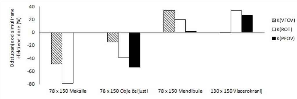
Slika 80. Odstupanja efektivne doze izračunate konverzijskim faktorima E/CBCTDI<sub>2</sub> danim za veličinu FOV-a (K(VFOV)), kut rotacije rendgenske cijevi (K(ROT)) i položaj FOV-a (K(PFOV)) od simulirane efektivne doze za sve simulirane kliničke protokole (100 kV, 360°)
