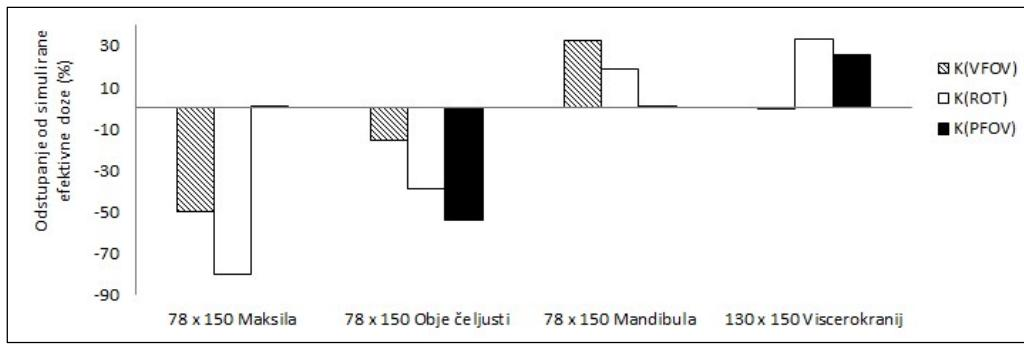
Slika 79. Odstupanja efektivne doze izračunate konverzijskim faktorima E/CBCTDI<sub>2</sub> danim za veličinu FOV-a (K(VFOV)), kut rotacije rendgenske cijevi (K(ROT)) i položaj FOV-a (K(PFOV)) od simulirane efektivne doze za sve simulirane kliničke protokole (90 kV, 360°)
