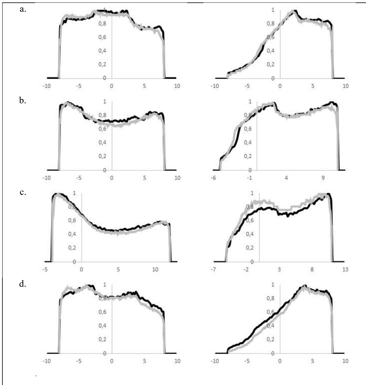
Slika 9. Usporedbi računalnih i eksperimentalnih fotonskih profila (lijevo) i postotnih dubinskih doza (desno) za svaki prethodno naveden scenarij. Sivom linijom prikazani su rezultati dobiveni radiokromskim filmom, a crnom rezultati dobiveni MC simulacijom. Svi prikazi normalizirani su na najveću vrijednost.
