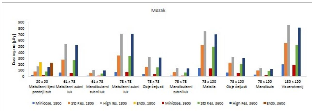
Slika 45. Doza mozga za različite umnoške struje i vremena ozračivanja za kut rotacije rendgenske cijevi od  $180^\circ$  i  $360^\circ$  (90 kV).
