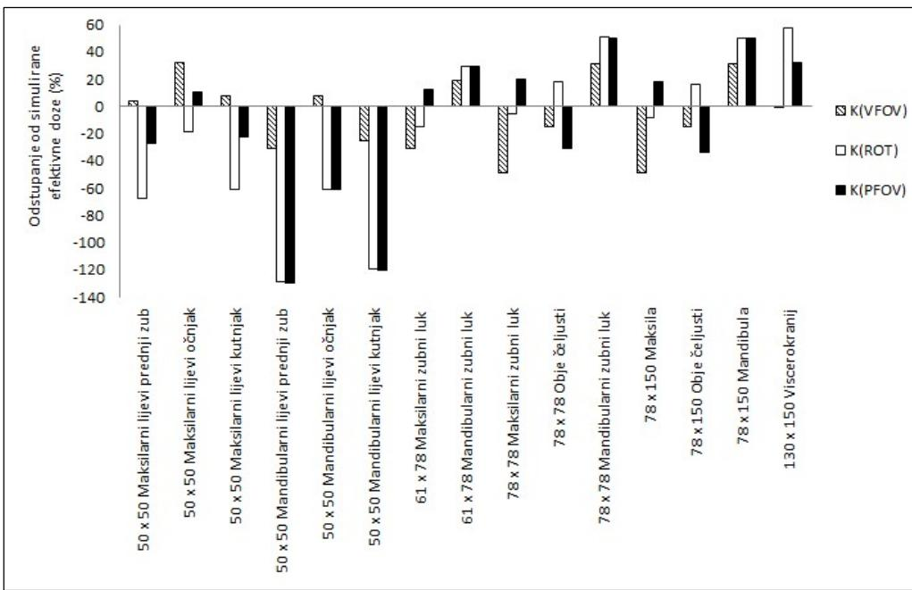
Slika 77. Odstupanja efektivne doze izračunate konverzijskim faktorima E/CBCTDI<sub>1</sub> danim za veličinu FOV-a (K(VFOV)), kut rotacije rendgenske cijevi (K(ROT)) i položaj FOV-a (K(PFOV)) od simulirane efektivne doze za sve simulirane kliničke protokole (100 kV, 360°)
