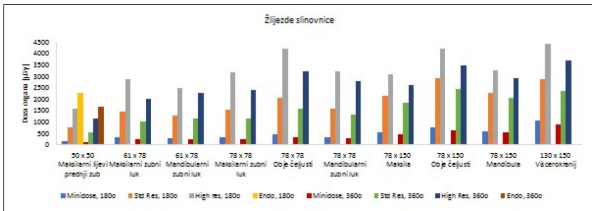
Slika 46. Doza žlijezda slinovnica za različite umnoške struje i vremena ozračivanja za kut rotacije rendgenske cijevi od  $180^\circ$  i  $360^\circ$  (90 kV).
