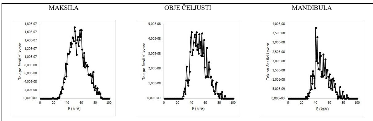
Slika 99. Energijski spektar fotonskog snopa u očnoj leći za simulirani CBCT uređaj pri naponu na rendgenskoj cijevi od 90 kV i kut rotacije rendgenske cijevi od  $180^\circ$  za različite položaje središta FOV-a veličine  $78 \times 78 \text{ mm}^2$
