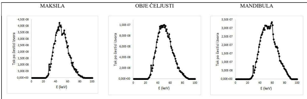
Slika 98. Energijski spektar fotonskog snopa štitnoj žlijezdi za simulirani CBCT uređaj pri naponu na rendgenskoj cijevi od 90 kV i kut rotacije rendgenske cijevi od  $180^\circ$  za različite položaje središta FOV-a veličine  $78 \times 78 \text{ mm}^2$
