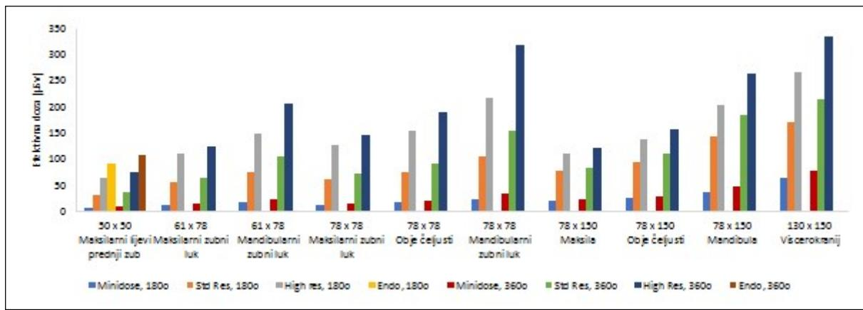
Slika 51. Efektivna doza za različite umnoške struje i vremena ozračivanja za kut rotacije rendgenske cijevi od  $180^\circ$  i  $360^\circ$  (90 kV).
