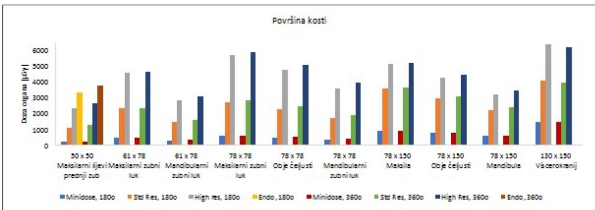
Slika 44. Doza površine kosi za kut rotacije rendgenske cijevi od 180° i 360° (90 kV).
