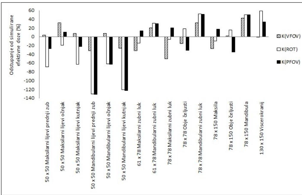
Slika 75. Odstupanja efektivne doze izračunate konverzijskim faktorima E/CBCTDI<sub>1</sub> danim za veličinu FOV-a (K(VFOV)), kut rotacije rendgenske cijevi (K(ROT)) i položaj FOV-a (K(PFOV)) od simulirane efektivne doze za sve simulirane kliničke protokole (90 kV, 360°)
