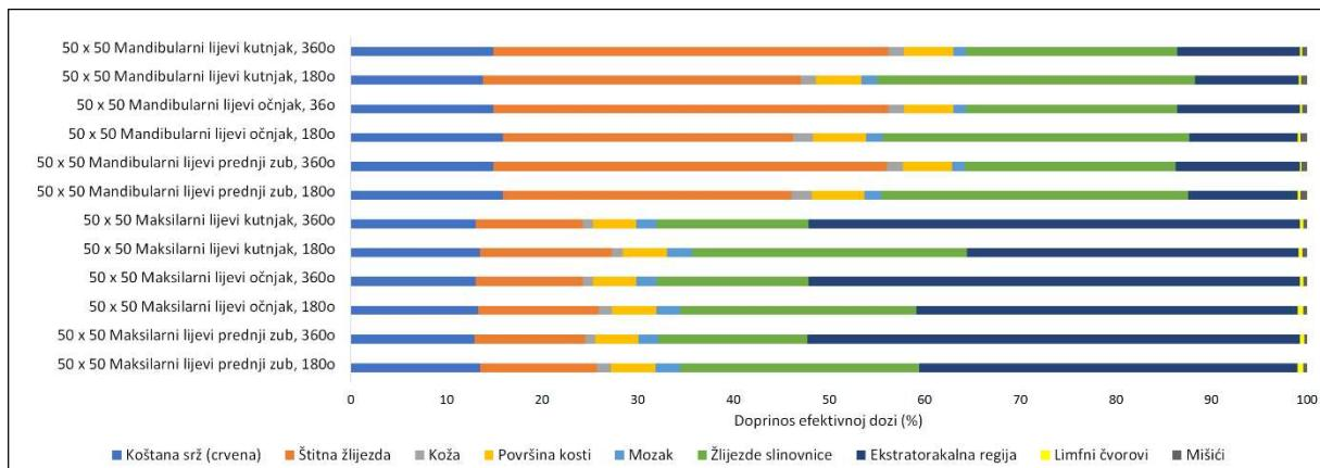
Slika 32. Doprinosi organa efektivnoj dozi za različite položaje FOV-a veličine  $50 \times 50 \text{ mm}^2$  na svakoj čeljusti za kut rotacije rendgenske cijevi od  $180^\circ$  i  $360^\circ$  (90 kV, Std Res).
