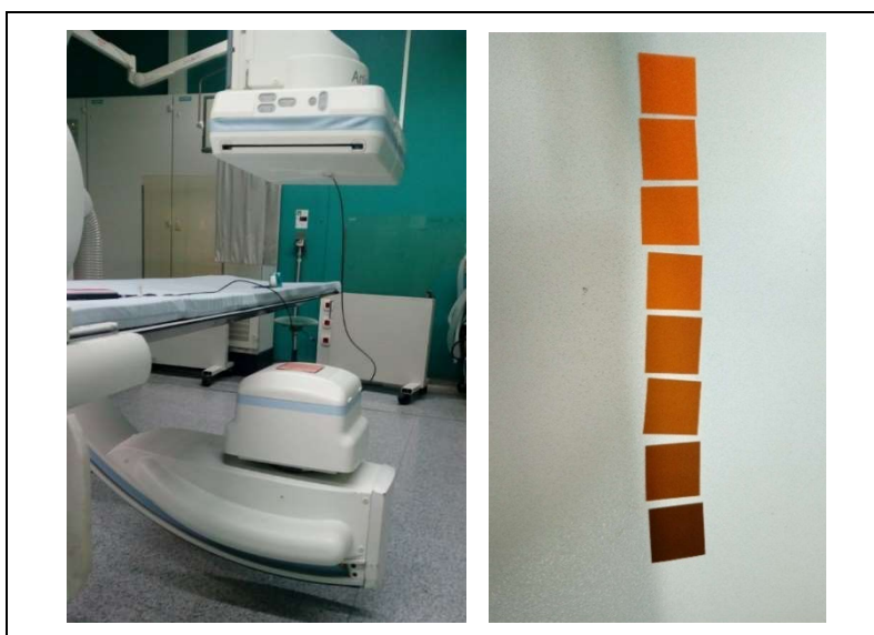
Slika 7. Rendgenski uređaj kojim su ozračivani radiokromski filmovi (lijevo) i ozračeni radiokromski filmovi (desno).
