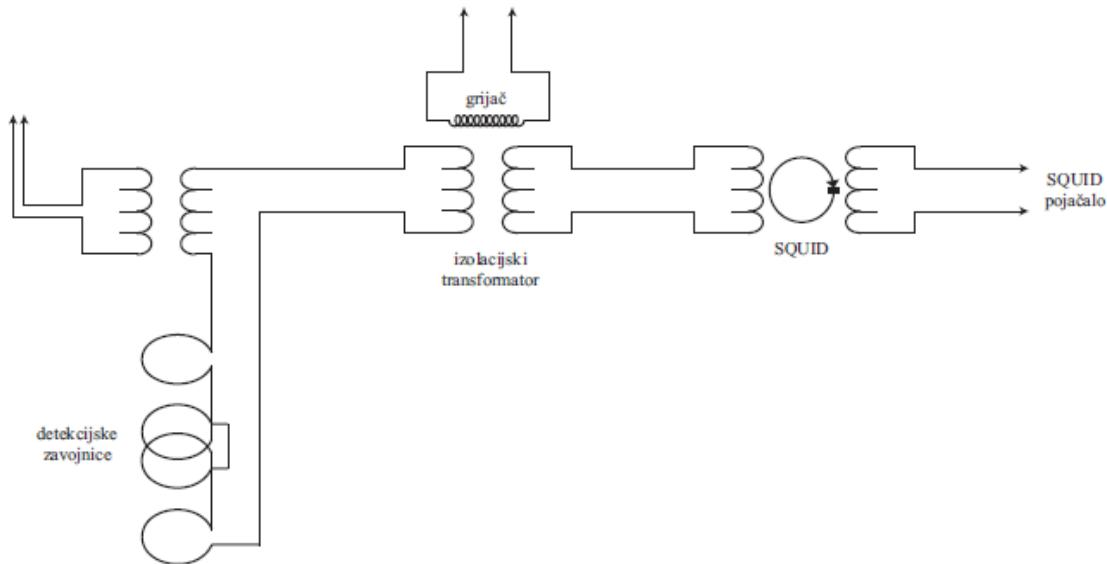
**Slika 4.3:** Sustav za mjerjenje magnetskog momenta u smjeru vanjskog magnetskog polja
