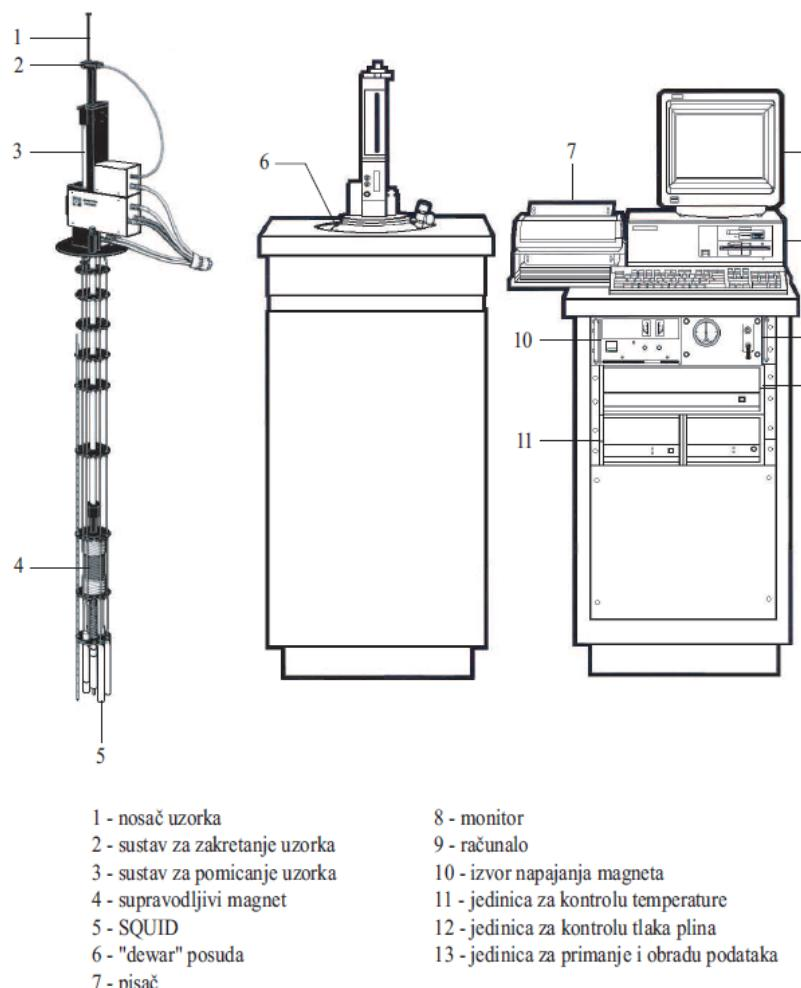
Slika 4.2: MPMS magnetometar
