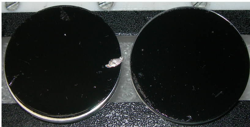
Slika 4.5: Čestice prašine iz JET-a na nosačima (stubovima).
