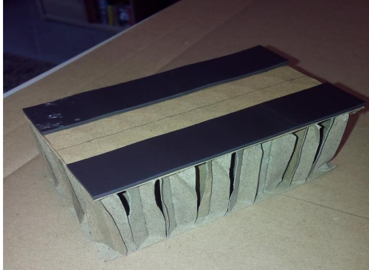
Slika 3. Zaljepljene kratke magnetske trake na malom kartonu (vozilo)
