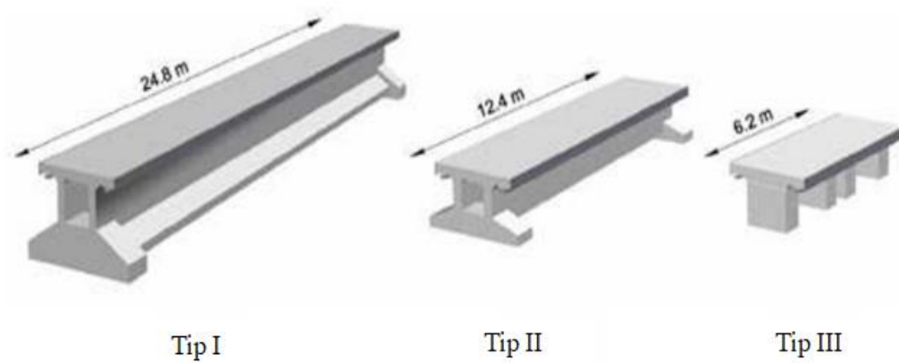
Slika 7. Standardni tipovi nosača Maglev sustava
