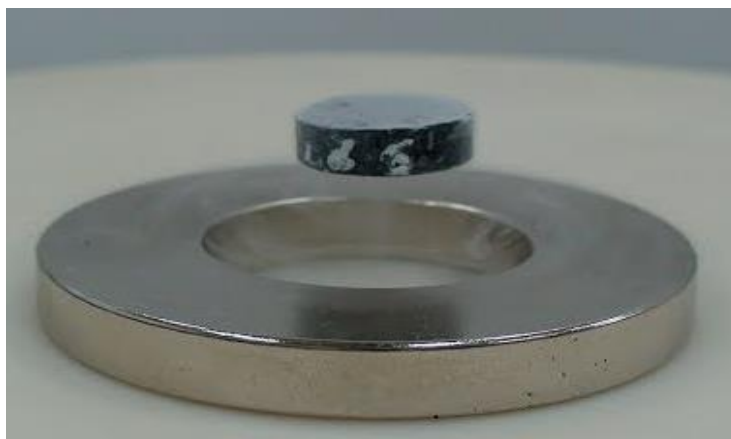
Slika 19. Levitacija magneta iznad supravodiča
