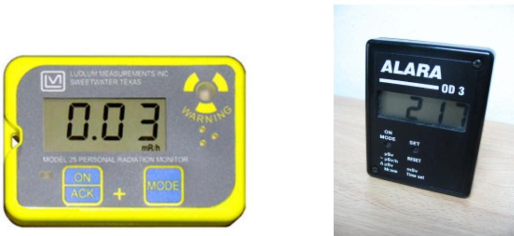
Slika 1.2: Aktivni elektronički dozimetri. [5]
