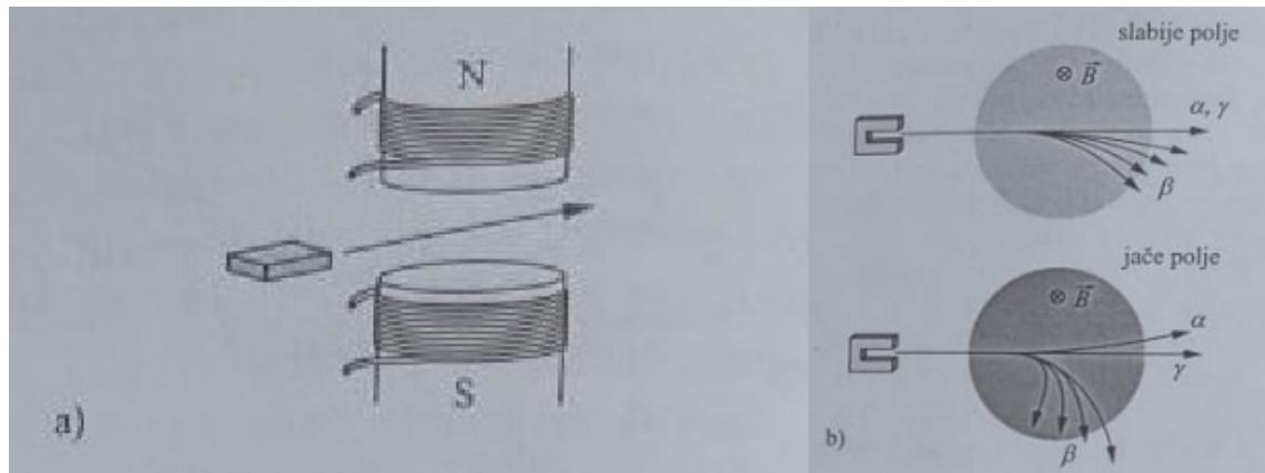
Slika 5.8: a) Uski snop radioaktivnih zraka iz izvora prolazi između polova jakog magneta. b) U dijelu prostora u kojem postoji vertikalno magnetsko polje (između polova magneta) alfa i beta zrake se zakreću u horizontalnoj ravnini. [15]
