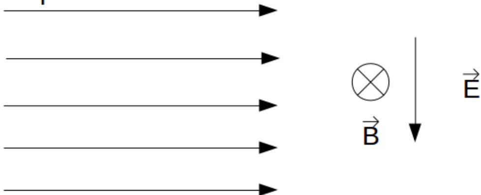
Slika 5.9: Beta čestice su usmjereni prema desno te nailaze na električno polje koje je usmjereni prema dolje i magnetsko polje koje je usmjereni u papir (ploču).
