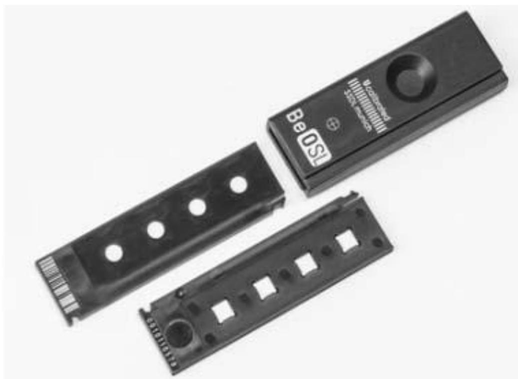
Slika 1.5: Dozimetar na bazi optički stimulirane luminiscencije. [7]
