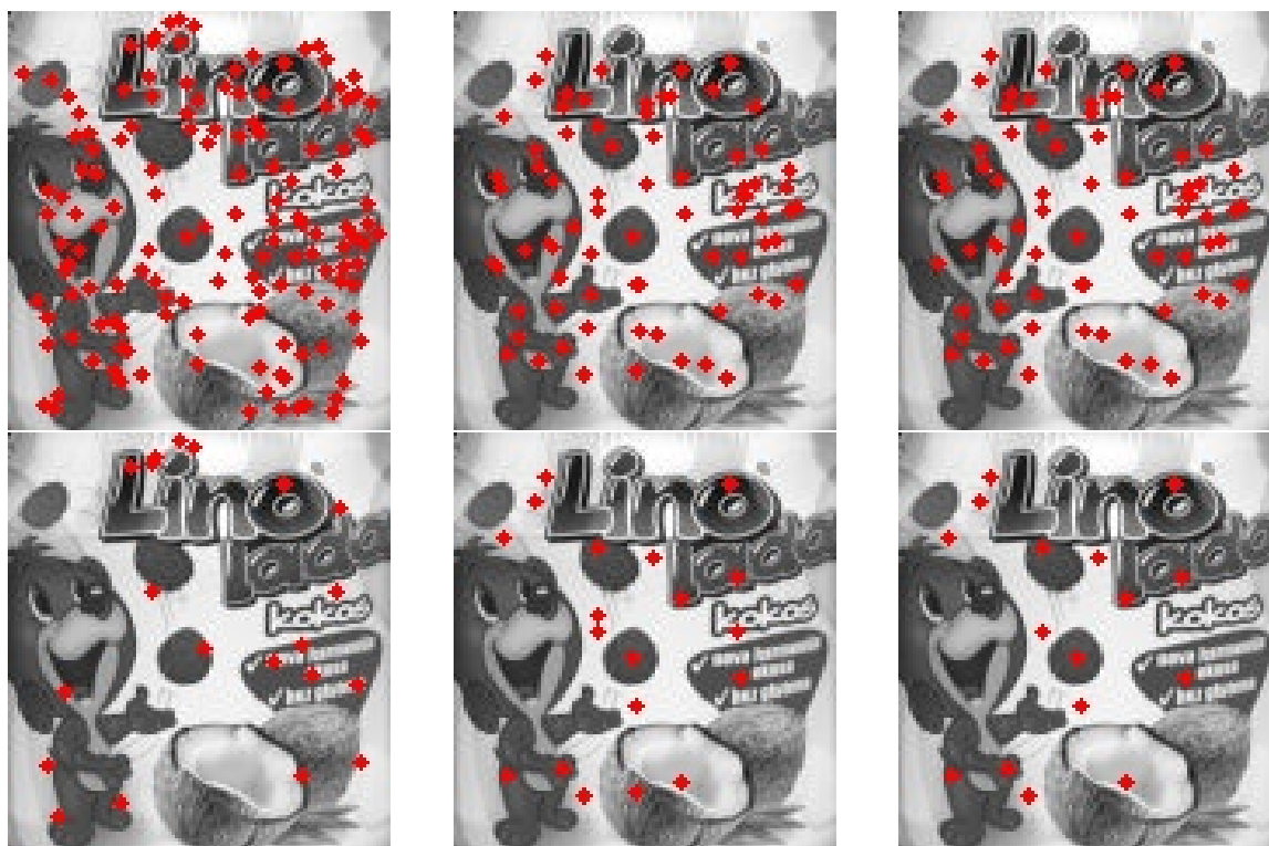
Slika 5.17: Prikaz ispravno (gornji red) i neispravno (donji red) povezanih ključnih točaka. Lijevi stupac pokazuje rezultat za SIFT algoritam, u sredini je SURF(300) i desno SURF(500).
