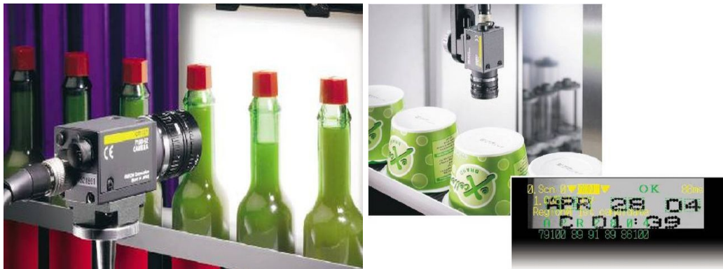
Slika 1.1: Očitavanje razine tekućine u boci (lijevo), provjera kvalitete ispisa roka trajanja (desno).
