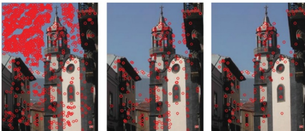
Slika 5.13: Lijevo su prikazani svi kandidati za ključne točke. U sredini su točke preostale nakon eliminacije na temelju kontrasta. Desno su su ključne točke preostale nakon eliminacije točaka koje su loše lokalizirane.[14]
