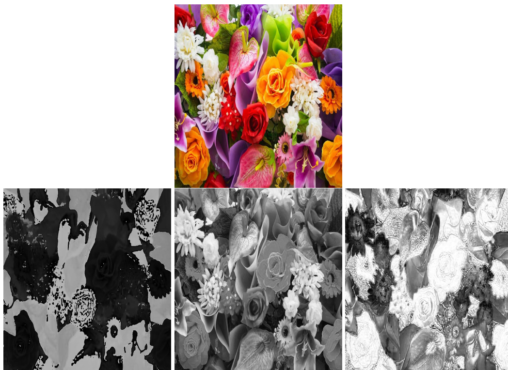
Slika 2.7: Komponente HLS spektra prikazujemo intenzitetom. Lijevo je komponenta H , u sredini L i desno S .
