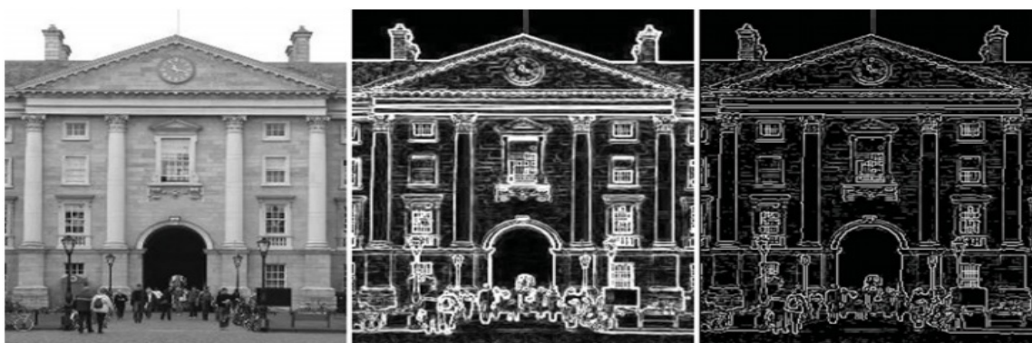
Slika 4.11: Slika u sivom području (lijevo), nakon detekcije svih rubova (sredina), poslije primjene non-maximum suppression.[6]
