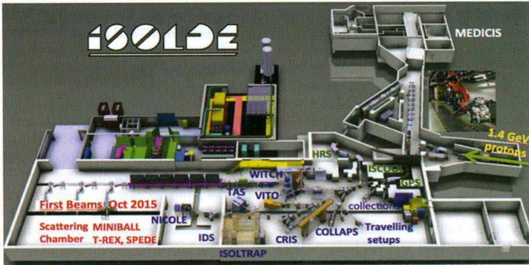
Slika 3.1: Skica postrojenja ISOLDE s označenim dijelovima. Snop protona (obično energije 1.4 GeV) dolazi iz protonsko-sinkrotronskog pojačivača te bombardira proizvodjacijsku metu. Nastali radioaktivni snop preko masenih separatora HRS i GPS odlazi do niskoenergijskih linija (COLLAPS, CRIS, MEDICIS i dr.) i visokoenergijskih linija, prije kojih još prolazi kroz akceleratorski kompleks REX i HIE-ISOLDE. Preuzeto iz [14].
