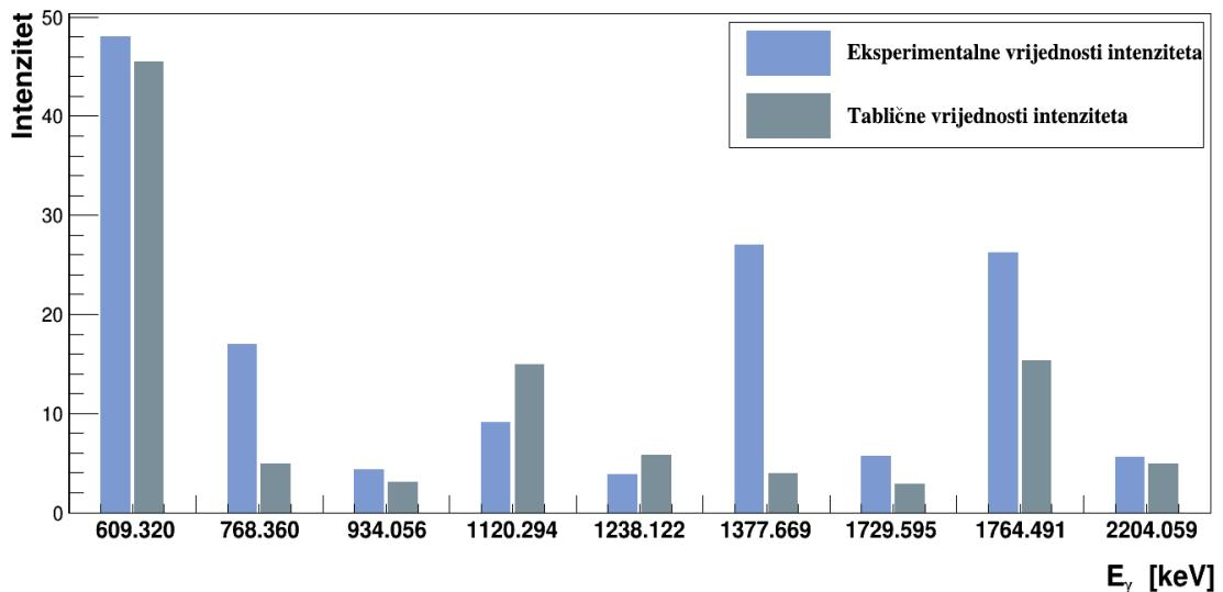
Slika 4.14: Usporedba eksperimentalnih vrijednosti intenziteta s tabličnim vrijednostima intenziteta elektromagnetskih prijelaza u  $^{214}\text{Po}$  dobivenih  $\beta^-$  raspadom  $^{214}\text{Bi}$  i  $\alpha$  raspadom  $^{218}\text{Rn}$ , koristeći podatke iz tablice 4.3. Prikazane su energije tabličnih intenziteta većih od 2.5 %.
