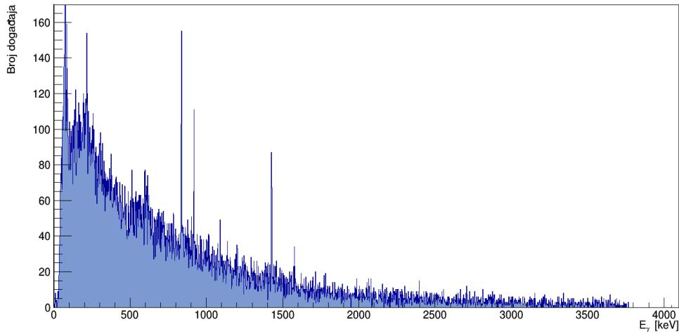
Slika 4.2:  $\gamma$  spektar prije Dopplerove korekcije za reakciju  $^{94}\text{Rb} + ^{208}\text{Pb}$  uz korištenje tanke mete.
