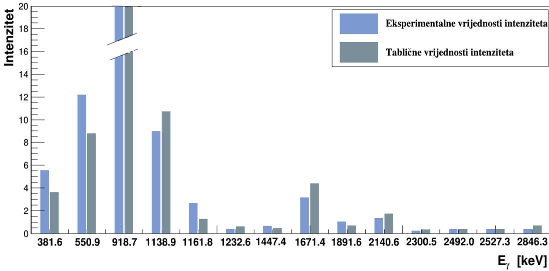
Slika 4.11: Usporedba izmjerene vrijednosti intenziteta s tabličnim vrijednostima intenziteta elektromagnetskih prijelaza  $^{94}\text{Zr}$  dobivenih  $\beta^-$  raspodom  $^{94}\text{Y}$ , koristeći podatke iz tablice 4.3. Prikazane su energije tabličnih intenziteta većih od 0.3 %. Radi preglednosti, najintenzivniji prijelaz ( $E_\gamma = 918.7$ ,  $I_{\text{norm}} = 100$ ) je nacrtan samo djelomično.
