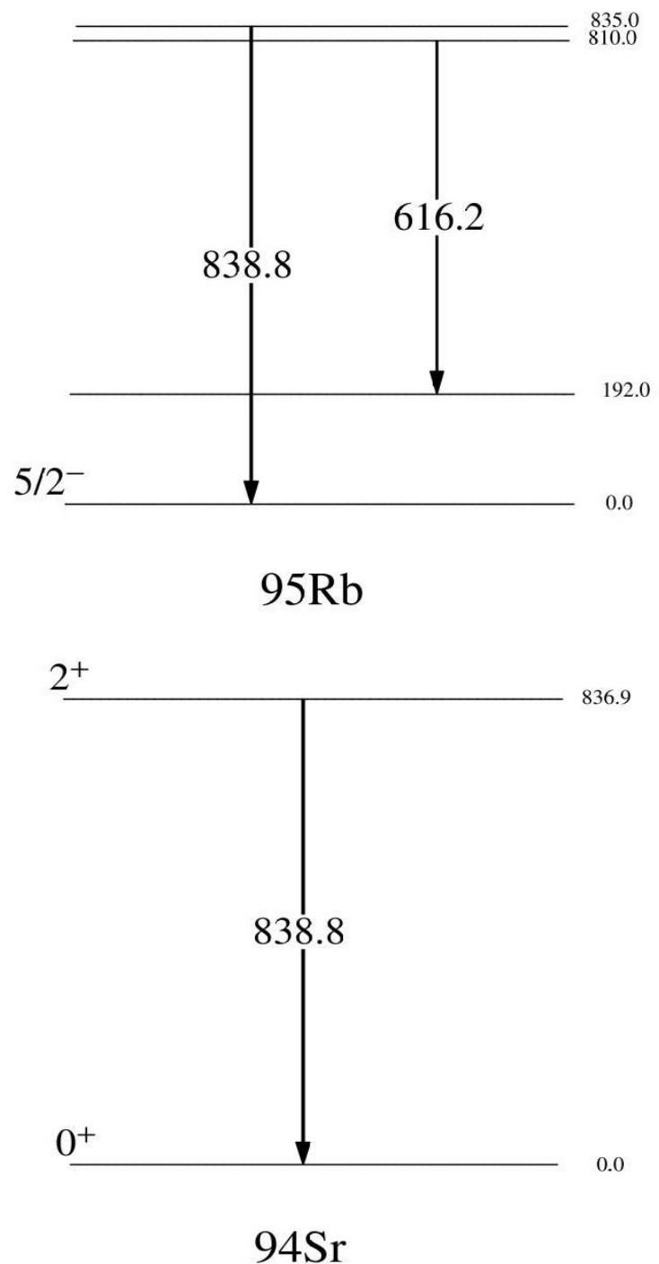
Slika 4.17: Prikaz energijskih nivoa i elektromagnetskih prijelaza lakšeg partnera reakcije  $^{94}\text{Rb} + ^{208}\text{Pb}$ .
