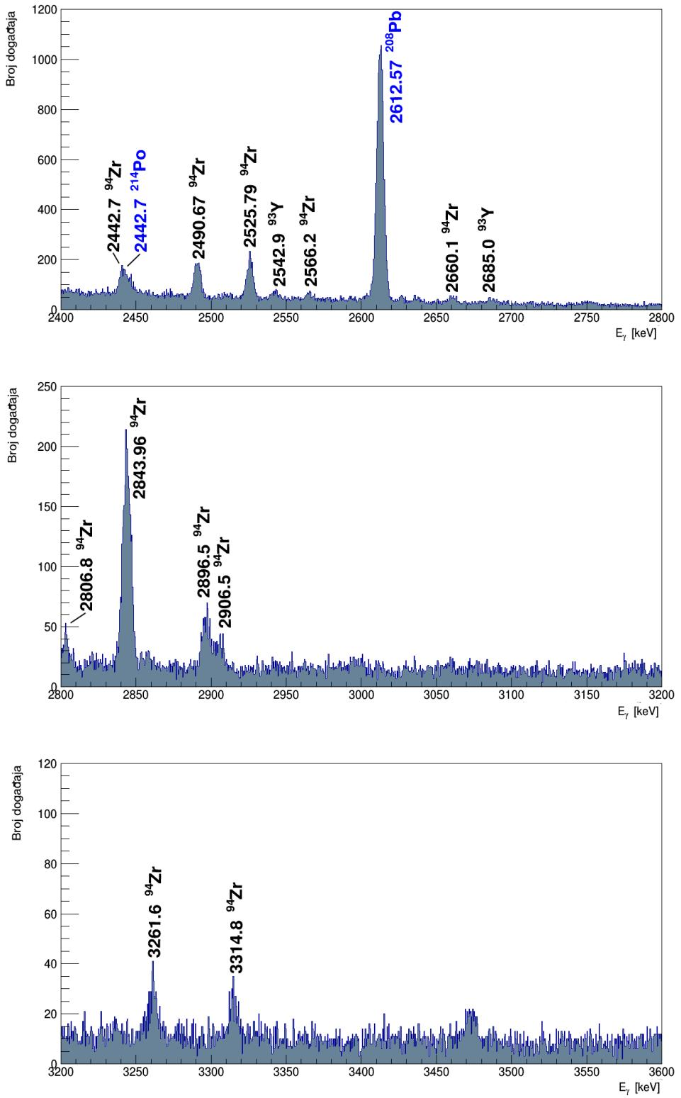
Slika 4.10: Spektar pozadinskog zrčenja nakon što je snop ugašen. Radi lakšeg prikaza spektar je razdijeljen na intervale od po 400 keV-a. Plavo označene energije predstavljaju izotope vezane uz prirodnu radioaktivnost, dok se crne oznake odnose na elektromagnetske prijelaze u izotopima nastalim raspadom  $^{94}\text{Rb}$ .
