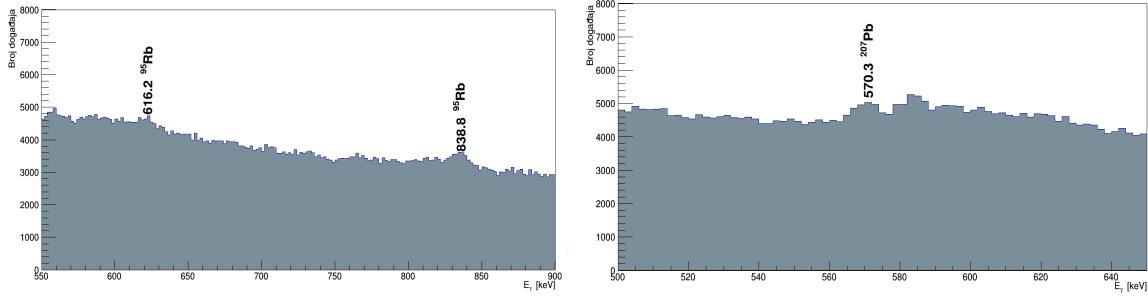
Slika 4.22: Usporedni prikaz (uvećano sa slika 4.16 i 4.18) identificiranih  $\gamma$ -vrhova izotopa  $^{95}\text{Rb}$  (lijevo) i  $^{207}\text{Pb}$  (desno). Prikazane su energije dobivene prilagodbom Gaussove funkcije.
