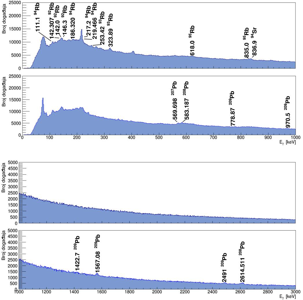
Slika 4.20:  $\gamma$  spektar koji odgovara promptnom vrhu i koji je Doppler korigiran za  $^{94}\text{Rb}$  (gornji red), odnosno  $^{208}\text{Pb}$  (donji red). Radi lakšeg prikaza spektar je razdijeljen na 2 dijela. Prikazani su identificirani  $\gamma$ -vrhovi s tabličnim energijama  $E_\gamma$ .
