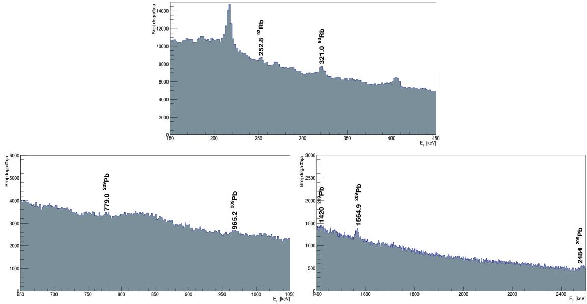
Slika 4.21: Usporedni prikaz (uvećano sa slika 4.16 i 4.18) identificiranih  $\gamma$ -vrhova izotopa  $^{93}\text{Rb}$  (gore) i  $^{209}\text{Pb}$  (dolje lijevo i dolje desno). Prikazane su energije dobivene prilagodbom Gaussove funkcije.
